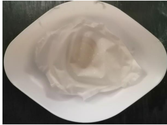
Figura 13.- Película de celulosa resultado del tratamiento alcalino, mostrando propiedades mecánicas y ópticas interesantes para su aplicación en distintos productos. Se observa que hay debajo una moneda de 10 pesos mexicanos.
