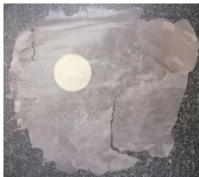
Figura. 22.- Película transparente obtenida tras la separación de las secciones de menor tamaño mediante una malla de nylon de 38 \mu\text{m} , reteniendo la mayor parte de las
