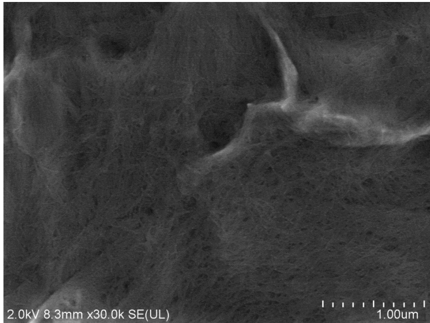
Figura 25.- Micrografía obtenida mediante SEM de la nanolámina de celulosa, mostrando su composición de nanofibras embebidas a la superficie.
