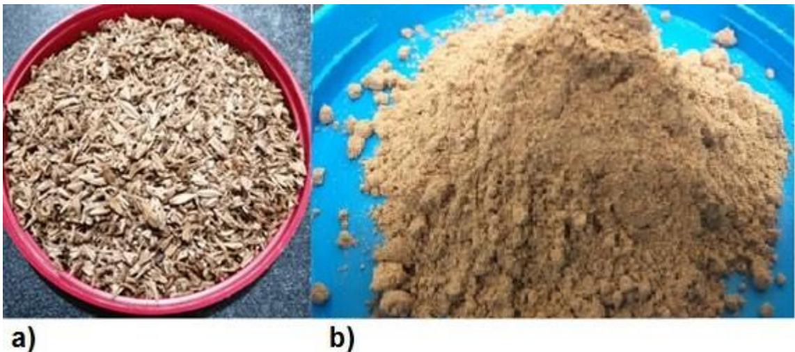
Figura 12.- a) Grano de BCM casi entero, el cual es utilizado en otros reportes y con el que se trabaja, b) muestra de BCM fina, resultado de la molienda y el tamizado con un tamaño de partícula de entre 54 – 105 \mu\text{m} .
