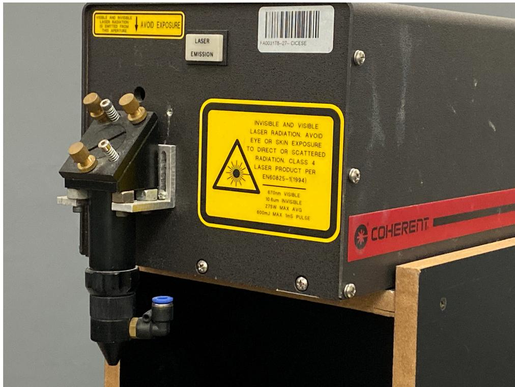
**Figura 4.** Láser de CO<sub>2</sub> modelo DIAMOND 150K, de Coherent Inc.
