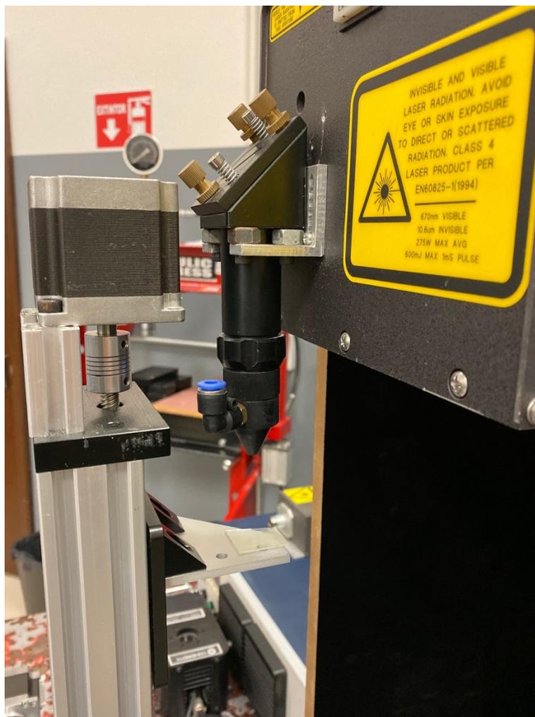
**Figura 5.** Arreglo experimental para el tratamiento láser. La película delgada se monta en el sistema de traslación compuesto por platinas, motores a pasos y un controlador Arduino, para trasladar la muestra, manteniendo fijo el haz láser.
