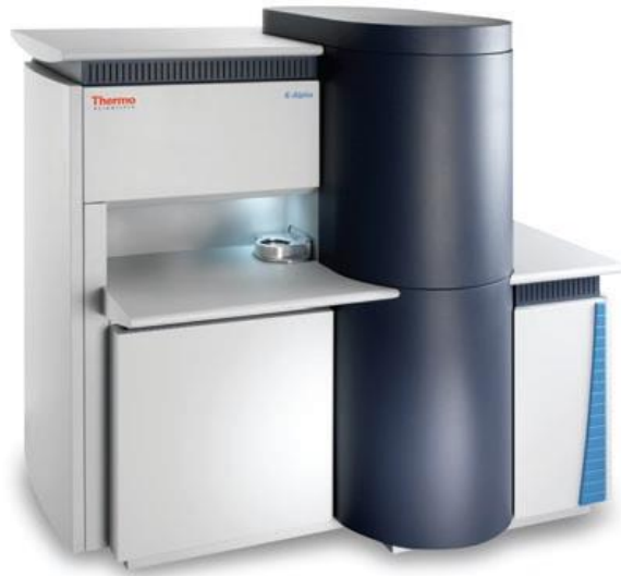
Figura 2.9 Equipo XPS K-Alpha Thermo Scientific, utilizado para la caracterización del material híbrido.
