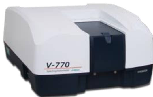
Figura 2.8. Equipo Jasco V-770 UV-Vis-NIR utilizado para la caracterización de las propiedades ópticas del material híbrido y los fotodetectores.
