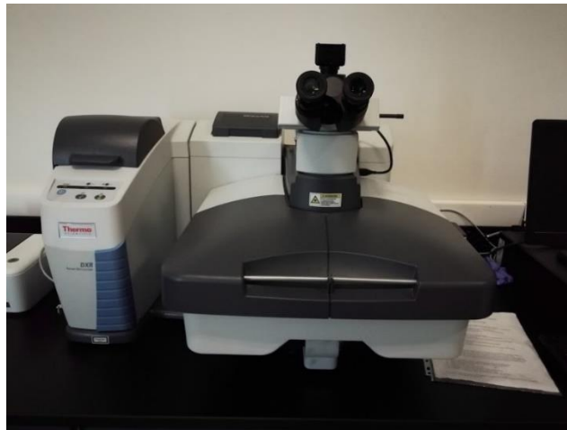
Figura 2.10 Equipo Thermo Scientific Raman DRX 2, utilizado para la caracterización del material híbrido.
