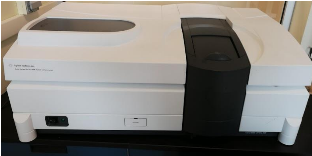
Figura 2.5 Equipo Cary 5000 UV-Vis-NIR utilizado para la caracterización de las propiedades ópticas de las nanopartículas de PbS y el GO/rGO.
