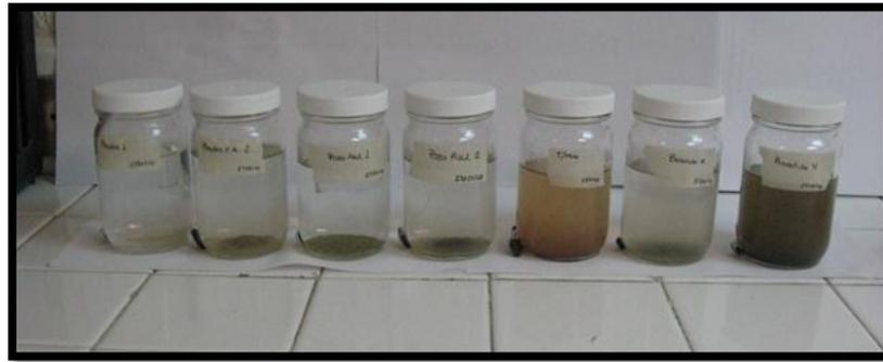
**Figura 6.** Enriquecimiento en medio líquido de las muestras, obsérvese que en el extremo de los frascos de vidrio se colocó un imán común.
