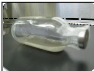
**Figura 13.** Concentración de la muestras mediante imanes de neodimio.
