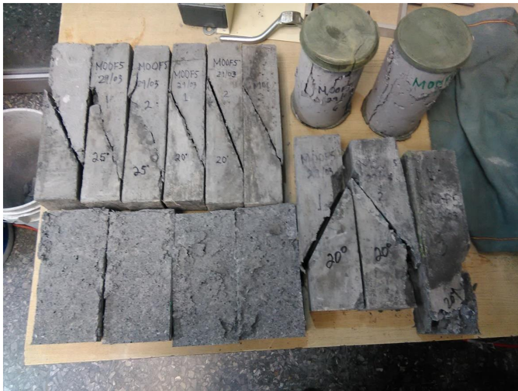
Figura 44.-Especímenes necesarios para análisis de cohesión y ángulo de fricción interna (Mohr- Coulomb).
