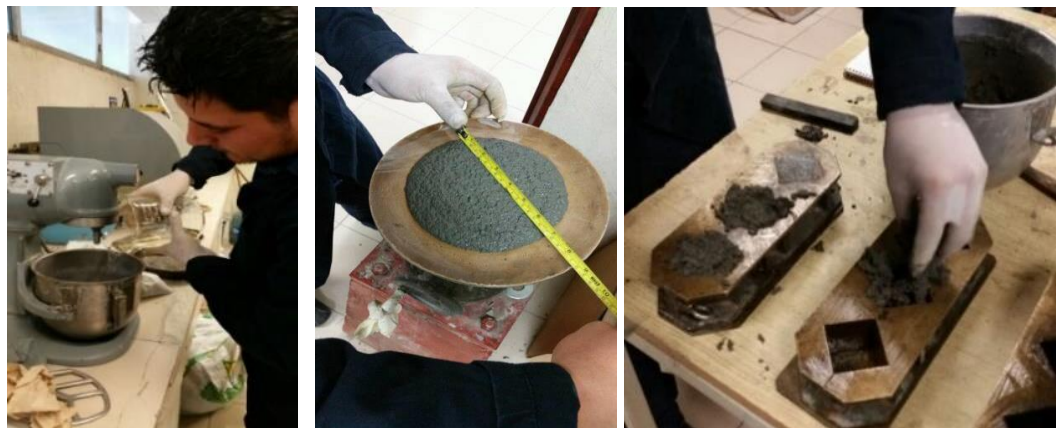
Figura 28.- Elaboración de especímenes cúbicos para ensayos de compresión y determinación de consistencia de mezclas de mortero.
