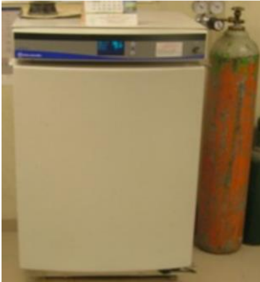
Figura 15.- Cámara de carbonatación acelerada
