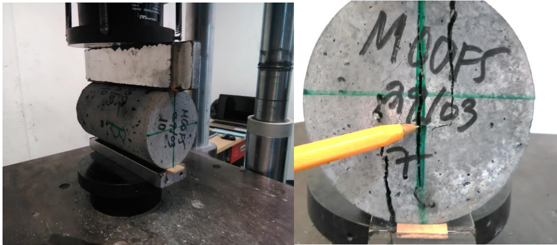
Figura 33.- Ensayo a compresión diametral y grieta en zona de tensión máxima.
