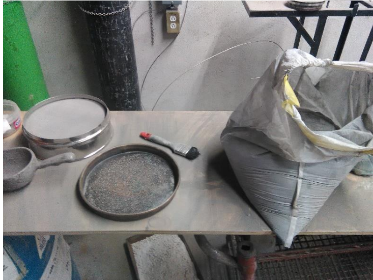
Figura 17.- Muestra de ceniza volante y posterior cribado por malla #100
