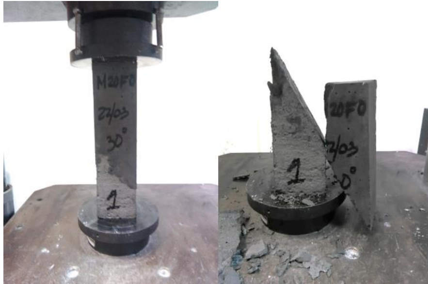
Figura 47.- Falla en el plano preferencial para M20F0
