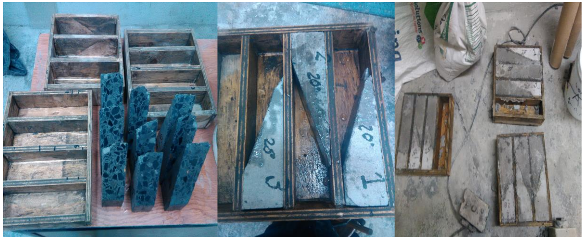
Figura 30.-Procedimiento de colocación de morteros de reparación a sustratos.
