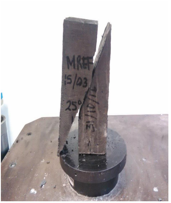
Figura 43.- Ensayo de corte inclinado a espécimen evaluando al mortero de referencia, M00F00. LLa falla fue inducida en un ángulo preferencial.
