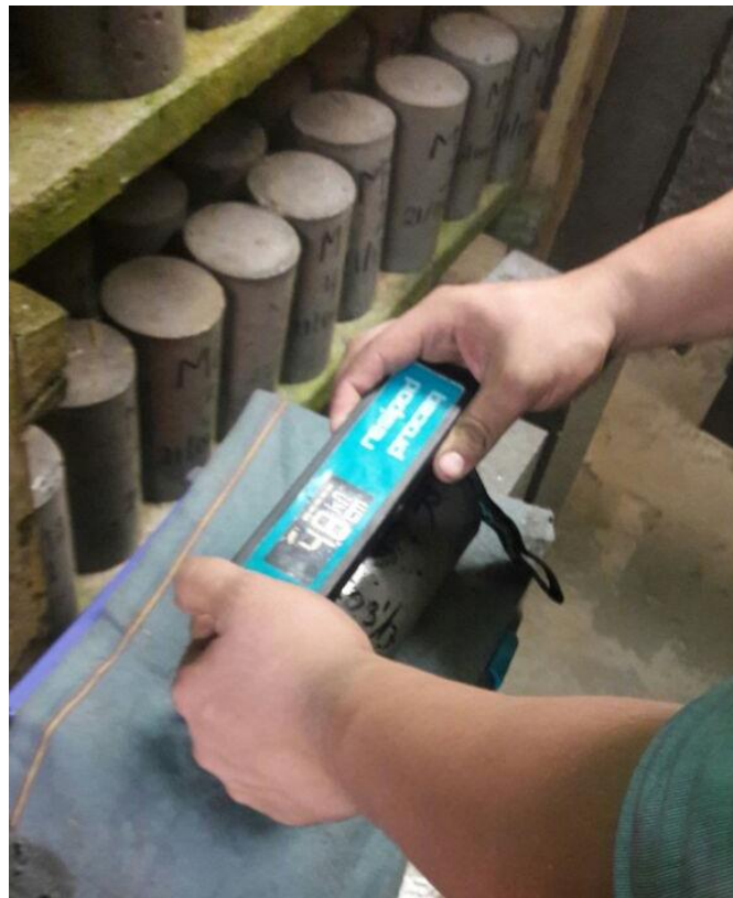
Figura 53.- Determinación de la Resistividad superficial de especimen dentro del cuarto humedo del IIC UANL.
