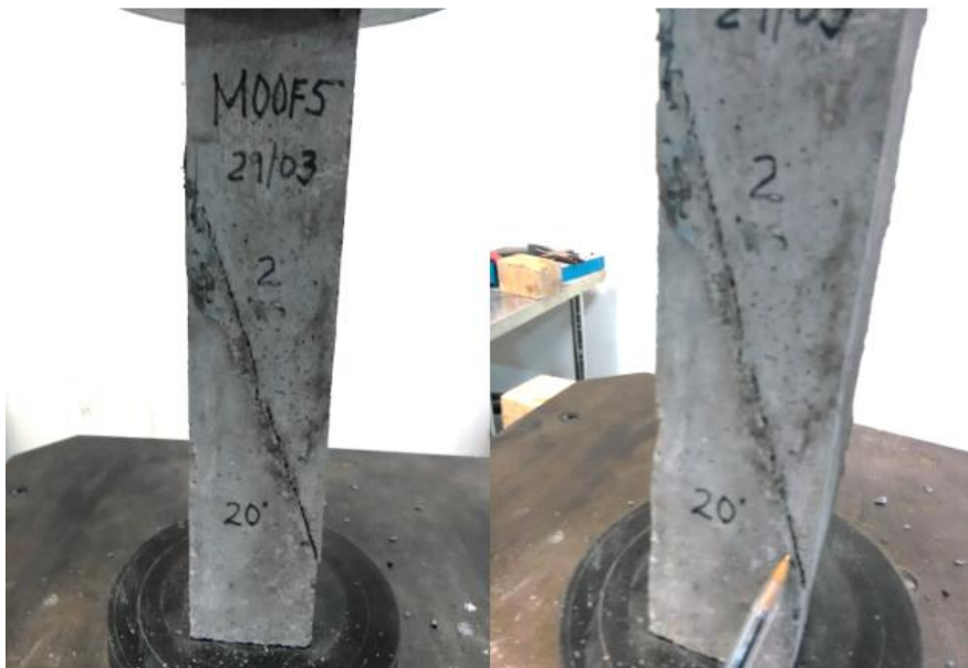
Figura 48.- Falla de M00F05, nótese el agrietamiento en la zona de interfaz sustrato-mortero de reparación.
