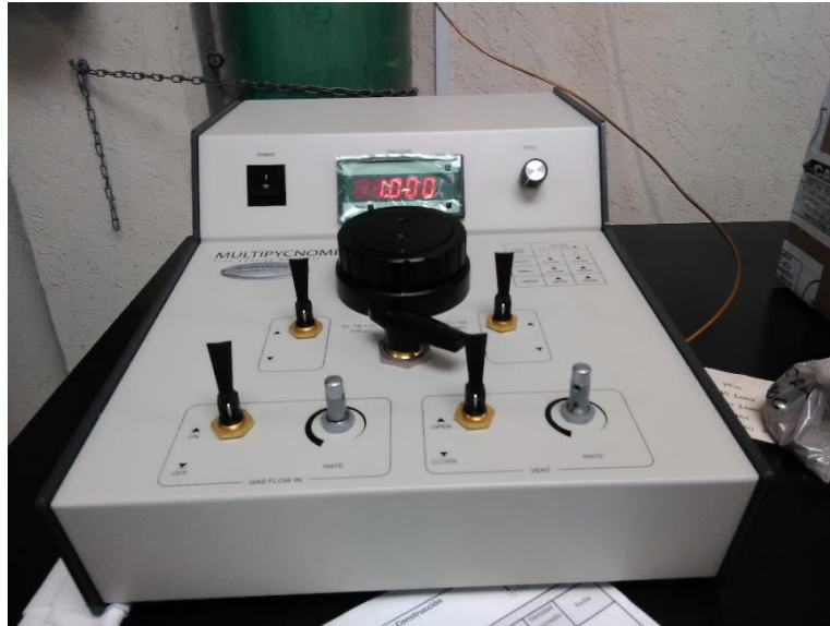
Figura 16.- Picnómetro para determinar densidad de los cementantes.
