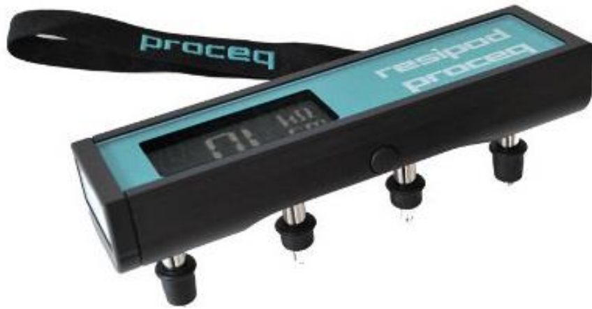
Figura 52.- Equipo Resipod (Método de Wenner).
