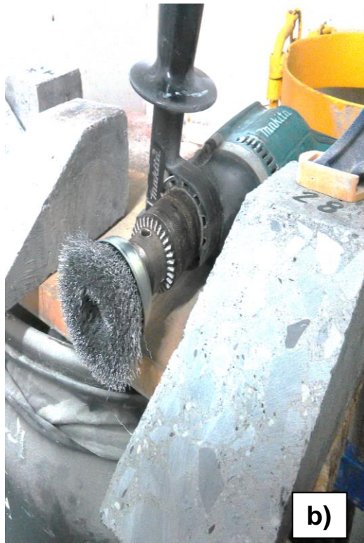
Figura 26.- a) Especímenes con los ángulos preferenciales de 20°, 25° y 30°, b) Equipo para limpieza superficial y c) Muestras listas para reparación
