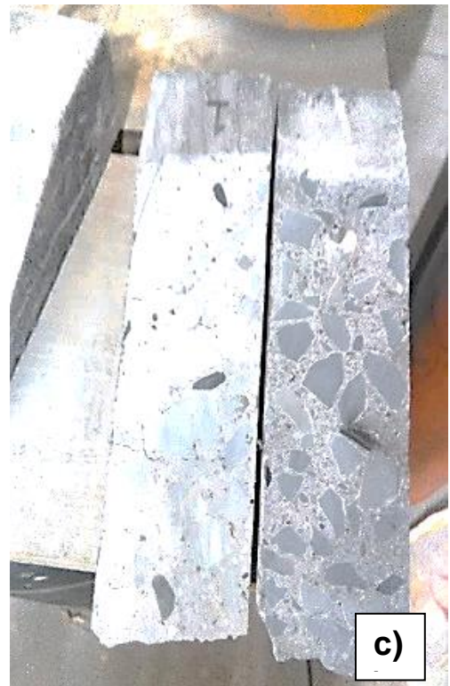
Figura 26.- a) Especímenes con los ángulos preferenciales de 20°, 25° y 30°, b) Equipo para limpieza superficial y c) Muestras listas para reparación
