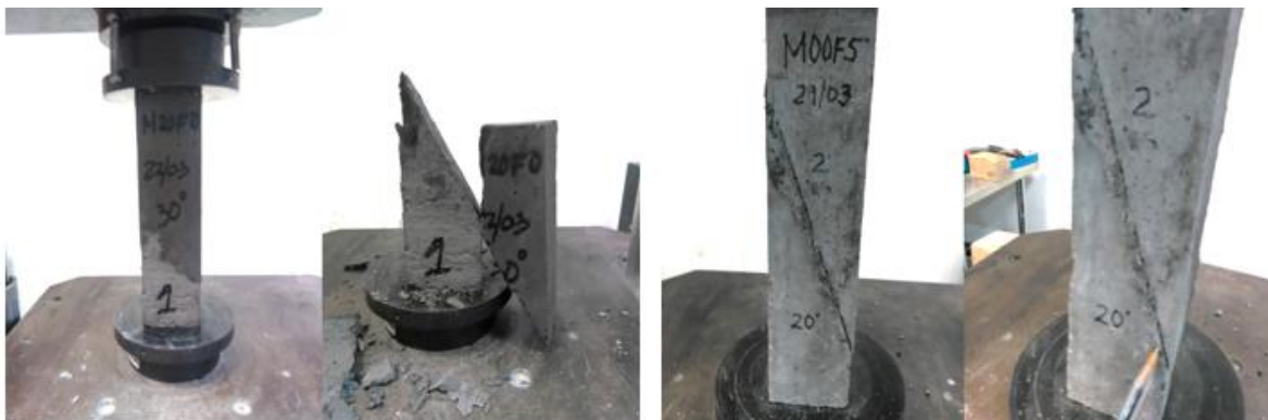
Figura 62.- Ejemplos de fallas presentadas, la inspección visual no encontró aplastamientos relevantes en los morteros ni en el sustrato.
