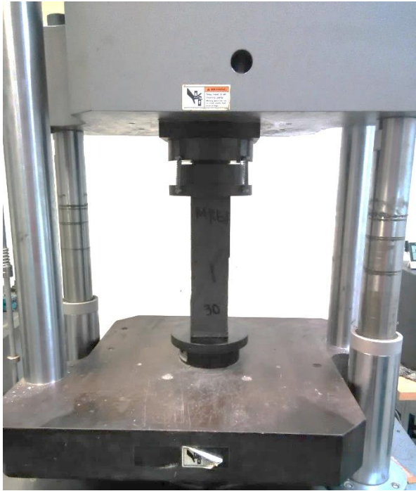
Figura 43.- Ensayo de corte inclinado a espécimen evaluando al mortero de referencia, M00F00. LLa falla fue inducida en un ángulo preferencial.
