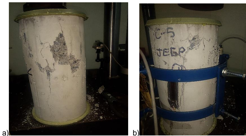
Figura 51. Patrones de falla en cilindros de concreto
