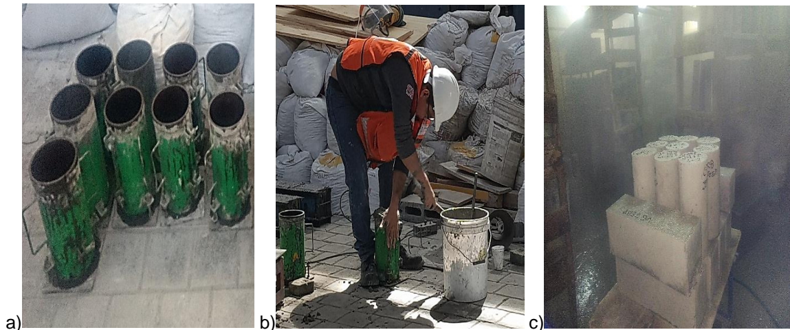
Figura 21. a) Moldes para cilindros previamente engrasados, b) Elaboración de cilindros, c) Colocación de especímenes en el cuarto de curado.
