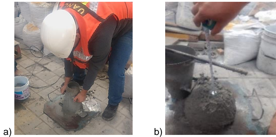
Figura 19. a) Levantamiento del cono, b) Medición del reventamiento obtenido.
