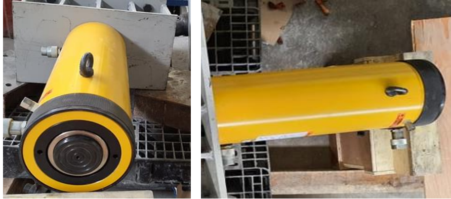
Figura 85. Cilindro hidráulico reversible de 100 Ton. de empuje y 45 Ton. de tirón.
