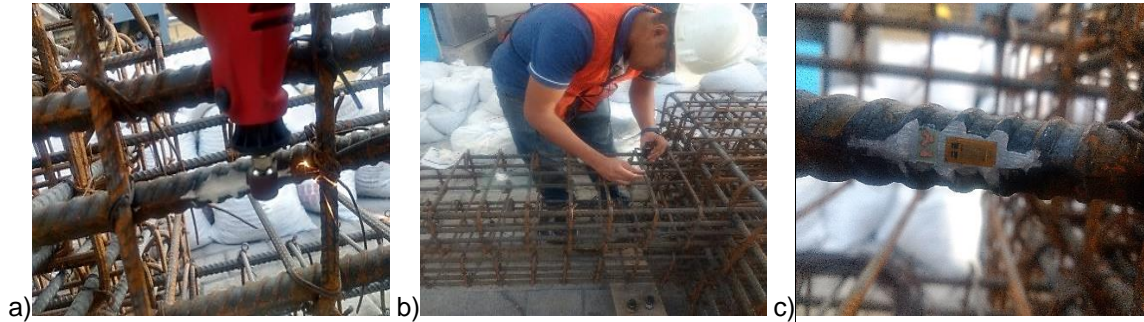
Figura 38. a) Pulido de zona, b) Colocación de químicos, c) Colocación y soldado de strain gauge.
