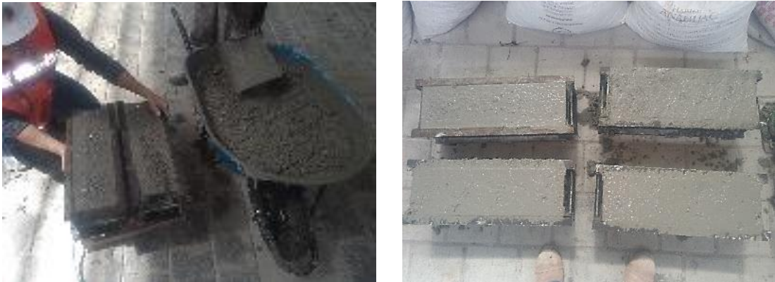
Figura 25. Colado de vigas, con medidas de 15 cm x 15 cm x 50 cm de longitud.
