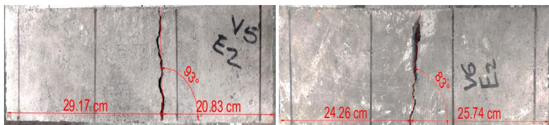
Figura 65. Modos de falla en vigas ( V - 5 ) y ( V - 6 ) del espécimen uno sin FA ( E - 2 ).
