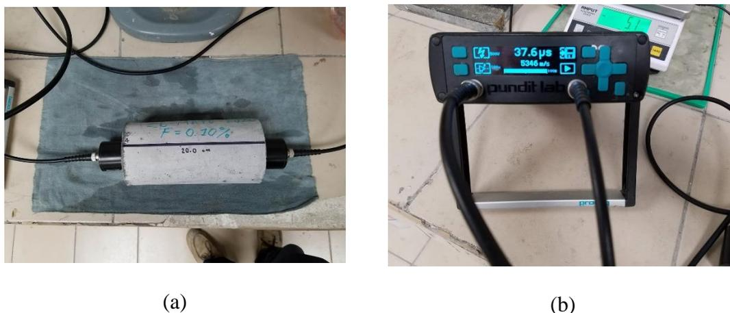
**Fig. 18.** (a) Especímenes de grout (b) Aparato de velocidad de pulso ultrasónico
