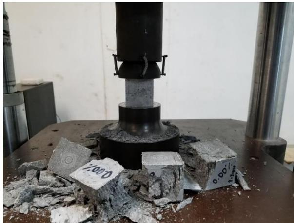
*Fig. 12. Ensayo a compresión de cubos de grout*
