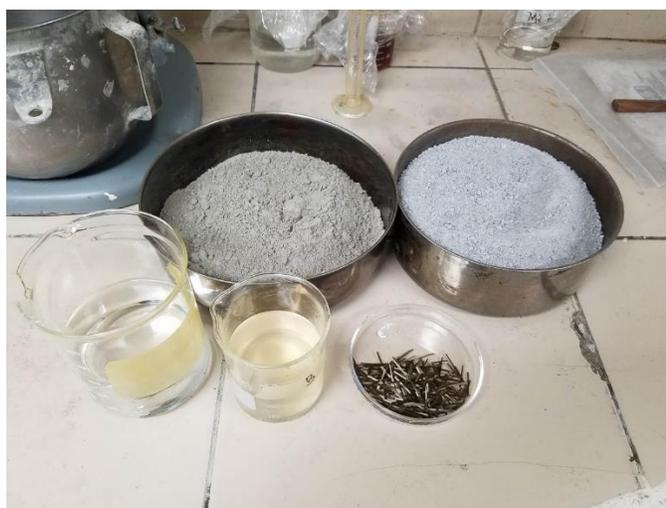
*Fig. 9. Materiales para mezclas de grout con fibras*
