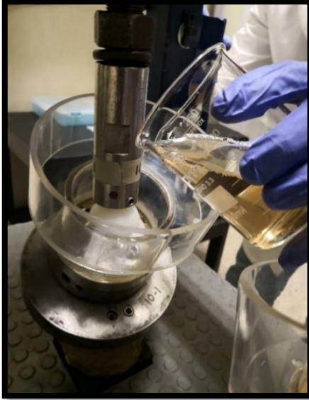
Figura 27. Colocación del lubricante en las estaciones de carga del simulador de prótesis de cadera FIME II.
