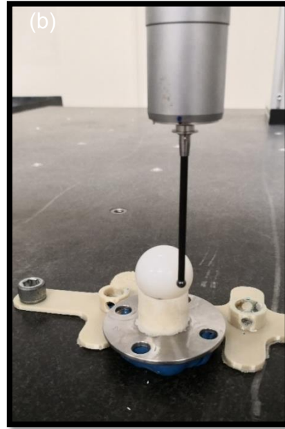
Figura 15. Máquina de medición de coordenadas (CMM). Procedimiento de medición de la superficie de la copa (a) y de la cabeza (b) para un espaciador de prótesis total de cadera previo a las pruebas de desgaste en el simulador.
