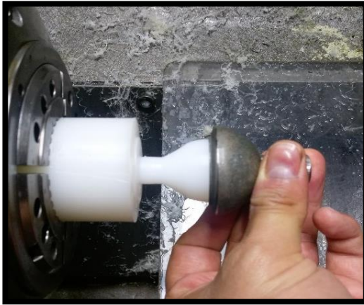
Figura 10. Comprobación de tolerancias de acuerdo a especificaciones.
