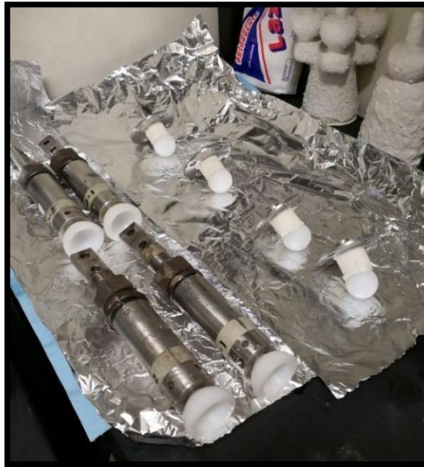
Figura 28. Muestras de polietileno posterior a lavado y en proceso de ser recolocadas en el simulador de prótesis de cadera FIME II.
