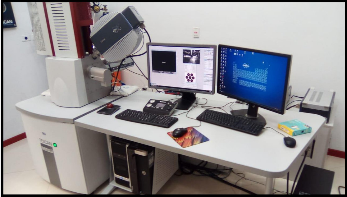
Figura 34. Microscopio electrónico TESCAN MIRA 3, utilizado en el presente estudio para la caracterización de las superficies de desgaste.
