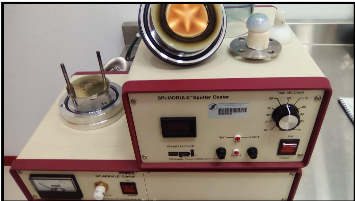
Figura 37. Cabeza femoral de polietileno con recubrimiento metálico, proceso realizado por el recubridor SPI-MODULE™ Sputter Coater
