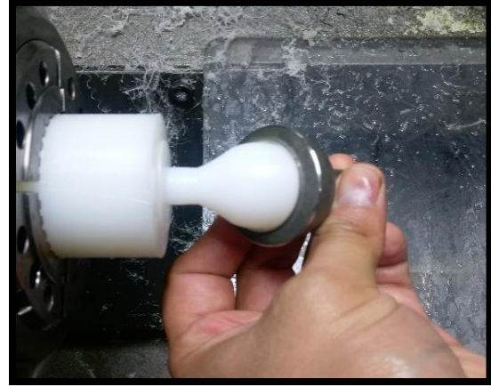
Figura 10. Comprobación de tolerancias de acuerdo a especificaciones.
