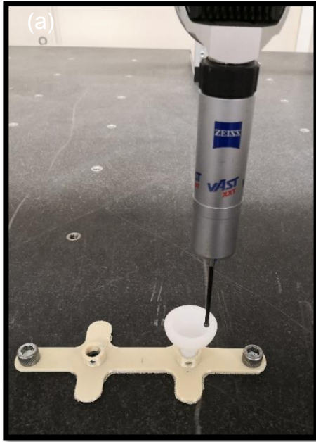
Figura 15. Máquina de medición de coordenadas (CMM). Procedimiento de medición de la superficie de la copa (a) y de la cabeza (b) para un espaciador de prótesis total de cadera previo a las pruebas de desgaste en el simulador.
