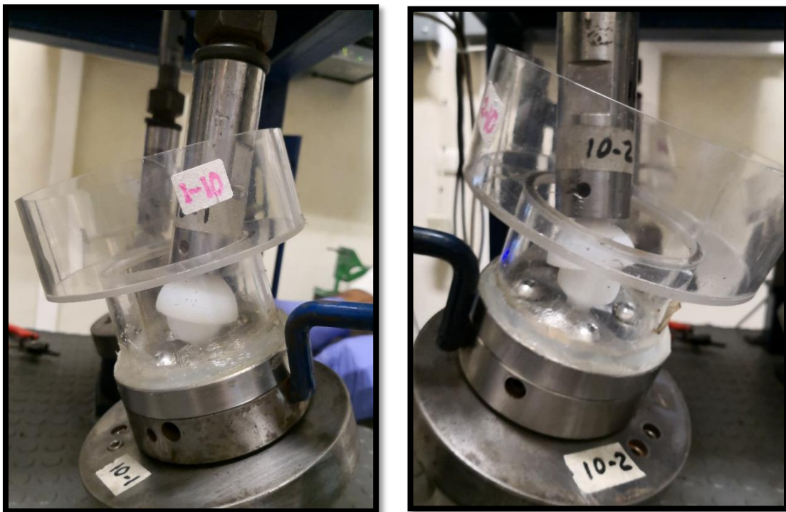
Figura 24. Copas y cabezas acetabulares radiadas y no radiadas, montadas en las estaciones de carga del simulador de prótesis de cadera FIME II.
