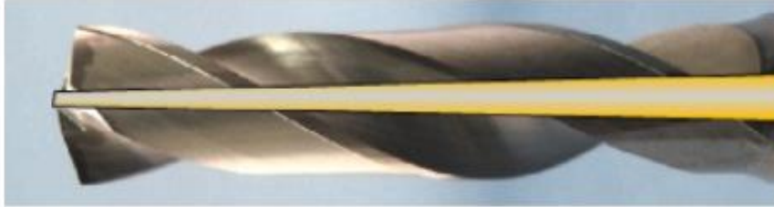
Figura 4.29. Ilustración del núcleo en una broca helicoidal [15].
