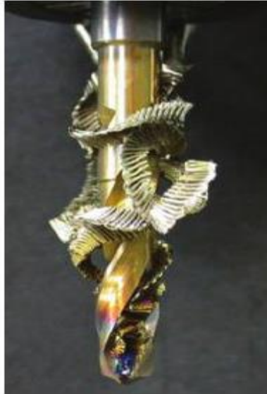
Figura 5.13 Ejemplo de una broca para barrenado con viruta enredada en el cuerpo [23].
