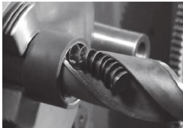
Figura 5.10. Viruta en forma cónica/sacacorchos [6]
