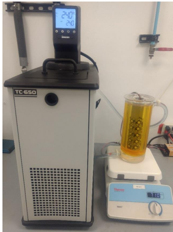
Figura 2.2. Sistema fotocatalítico empleado en la degradación de NM bajo irradiación de luz visible.
