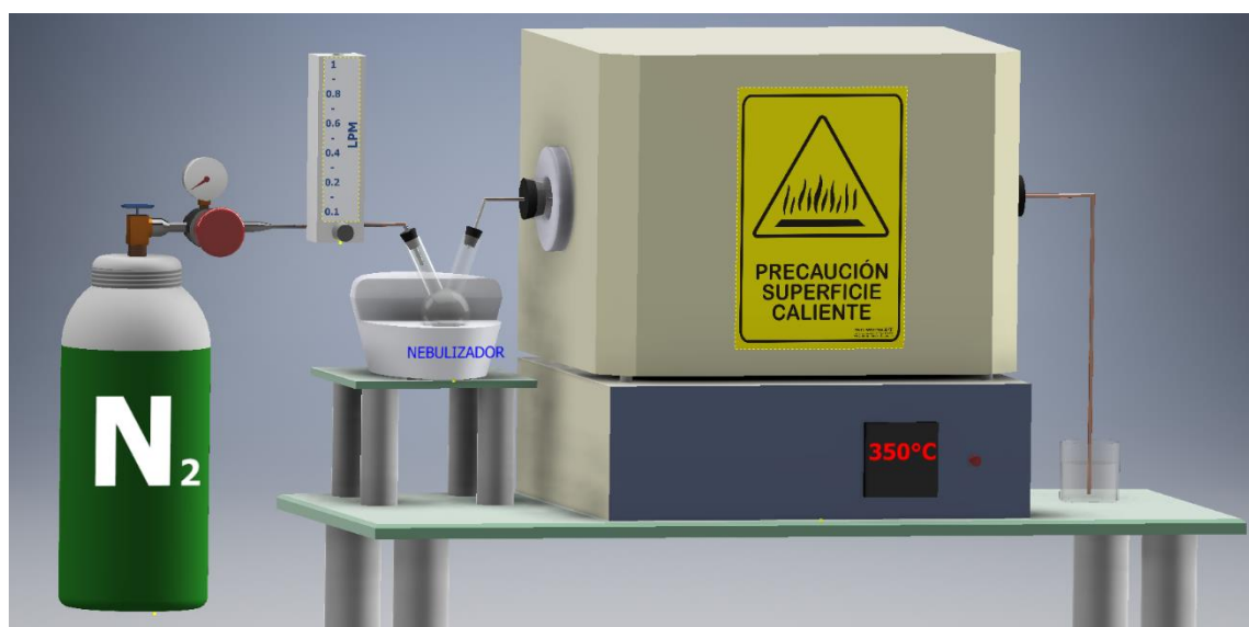
Figura 2.1. Diagrama de conexión utilizado en la síntesis de \text{BiVO}_4 mediante pirólisis por pulverización ultrasónica.
