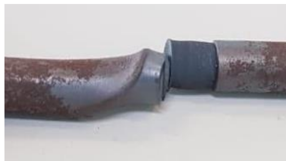
Anexo 2. 1 Imagen de probeta quebrada durante el ensayo de torsión en Gleeble.
