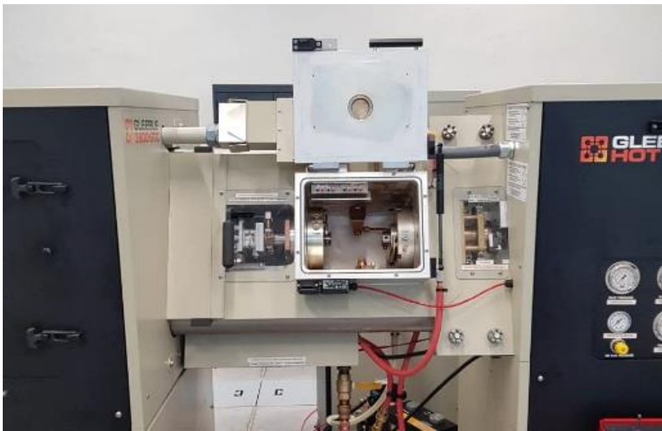
Figura 3. 5. Cámara de vacío del simulador termomecánico Gleeble.
