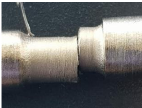
Anexo 2. 1 Imagen de probeta quebrada durante el ensayo de torsión en Gleeble.
