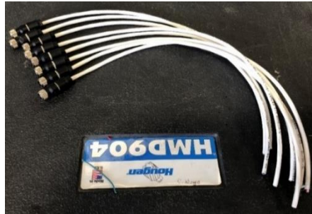
Figura 63. Cables que se encontraran dentro de la Timing Box.
