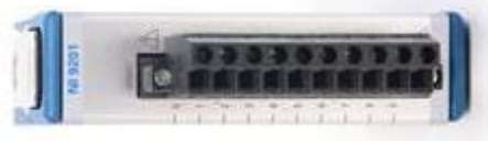
Figura 45. Tarjeta National Instruments utilizada para la adquisición de los datos [8].
