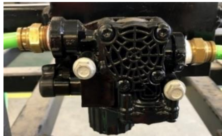
Figura 27. Ejemplo de válvula accionada por electroválvula.
