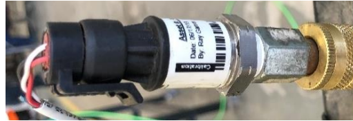
Figura 61. Conectores ya implementados con los cables y conectados a los transductores.
