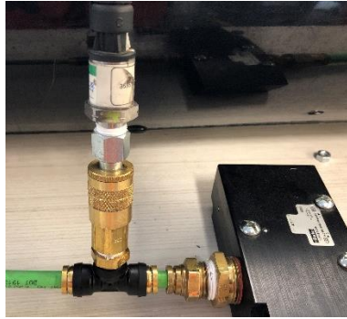
Figura 82. Arreglo de conector T en el puerto de salida de electroválvula.
