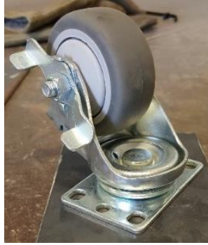
Figura 38. Llanta con freno utilizada en las mesas de pruebas.
