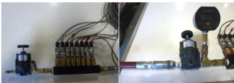
Figura 21. Riel para transductores en etapa de calibración [3].
