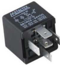
Figura 55. Relevador con bobina de 24Vdc.
