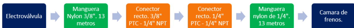
Figura 32. Diagrama de conexión de componentes neumáticos de la segunda configuración de validación.
