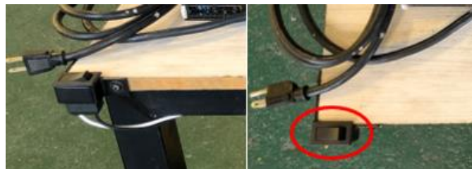
Figura 65. Interruptor utilizado para accionar solenoide de electroválvula.
