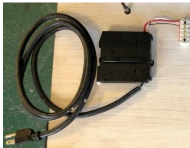
Figura 64. Fuente de voltaje sujeta a banca de pruebas.
