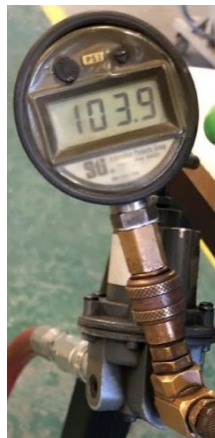
Figura 71. Sensor utilizado para la calibración y medición de presión.
