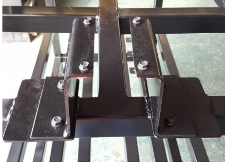
Figura 40. Soporte de válvula de freno de estacionamiento.
