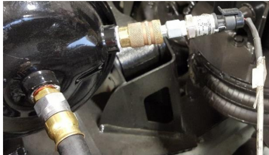
Figura 70. Transductores utilizados en las pruebas de verificación y pruebas experimentales.
