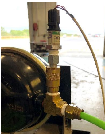
Figura 81. Conexión directa de conector T directa a cámara de frenos.
