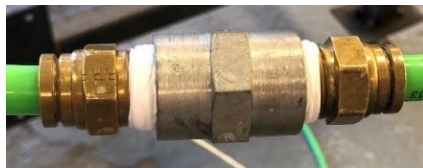
Figura 25. Ejemplo de arreglo de conectores rectos.
