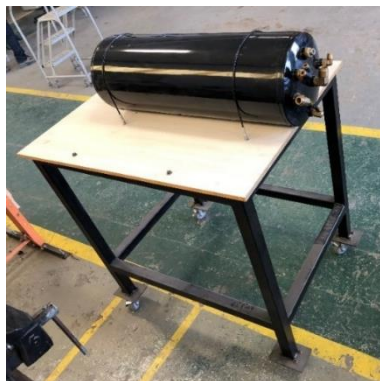
Figura 60. Tanque de almacenamiento utilizado para suministrar flujo de aire a los componentes en las mediciones.
