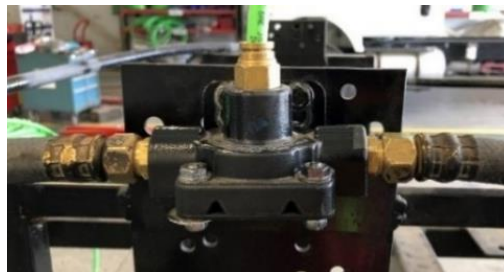
Figura 28. Ejemplo de válvula accionada por puerto de control.
