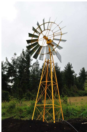
Figura 2.1 – Molino de Bombeo
