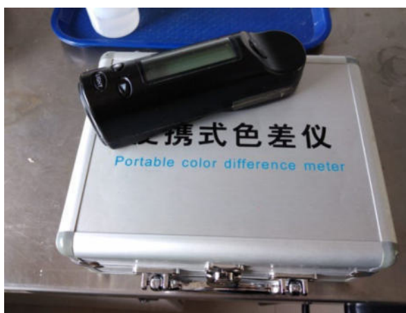
Figura 10. Equipo portátil SPEC para medir color.
