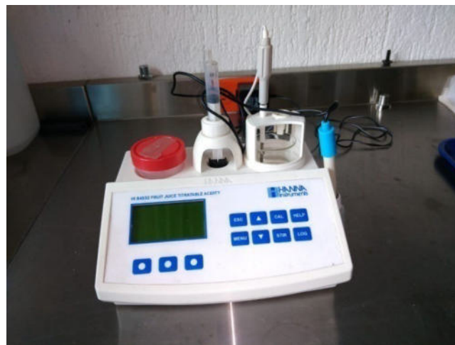
Figura 8. Equipo de medición de pH HANNA instruments; HI 84532, Fruit Juice Titratable Acidity, USA.
