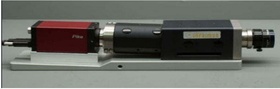
Figura 14. Cámara Pike F-210B acoplada al espectrógrafo V10E.
