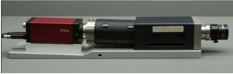
Figura 14. Cámara Pike F-210B acoplada al espectrógrafo V10E.
