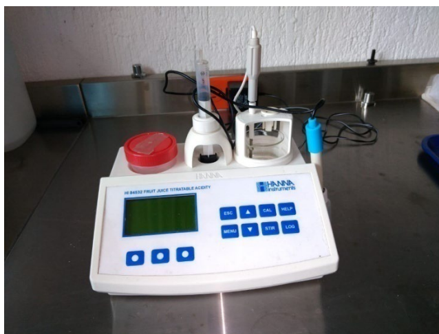
Figura 8. Equipo de medición de pH HANNA instruments; HI 84532, Fruit Juice Titratable Acidity, USA.
