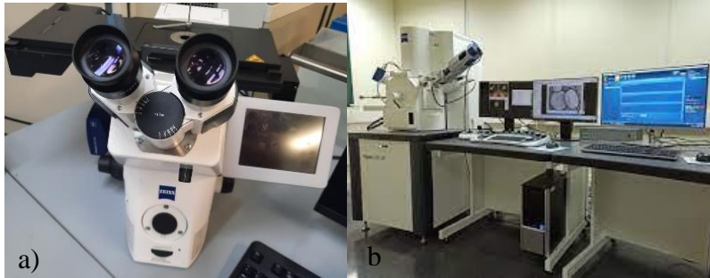
Figura 3.2 a) microscopio óptico (MO) ZEISS Axio Observer Z1m, b) microscopio electrónico de barrido de emisión de campo (FESEM) Sigma 300 PV.
