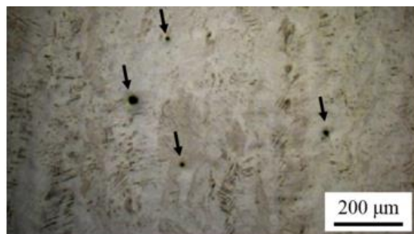
Figura 2.7 Defectos de porosidad
