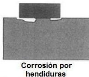
Figura 2.15 Ejemplo de corrosión por hendidura.
