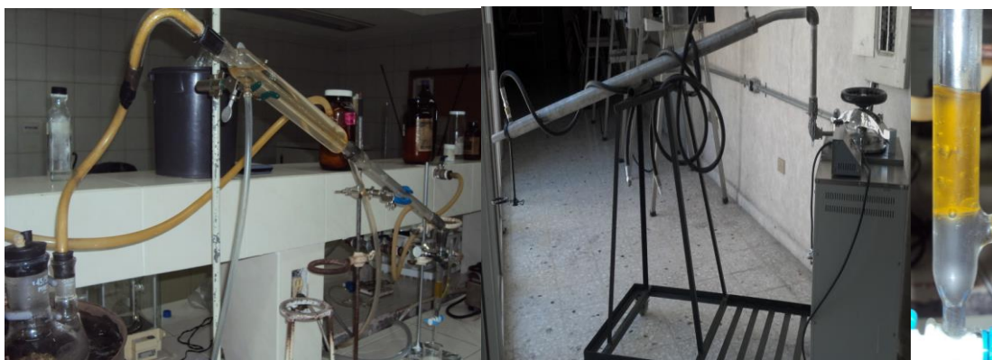
Figura 13. Destilador de arrastre de vapor adaptado con una autoclave a nivel laboratorio, para obtener mayores rendimientos de aceite esencial de orégano.
