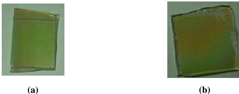
Figura 18. Depósitos del tercer lote. En la imagen (a) se presenta la muestra F0405 la cual fue sometida a un tiempo de depósito de 15 min, utilizando el blanco de TiN. En la imagen (b) exhibe el depósito de la muestra F0607 la cual fue sometida a un tiempo de depósito de 15 min, utilizando el blanco de Ti.
