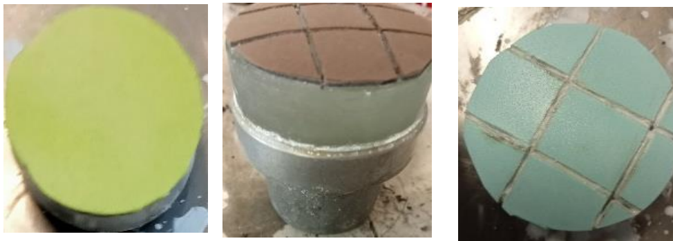
Figura 21. Proceso de pegado del pad a las herramientas de trabajo para el proceso de esmerilado y pulido. El pad verde (rugoso), pad café (suave a terciopelado) y pad azul (rugoso).
