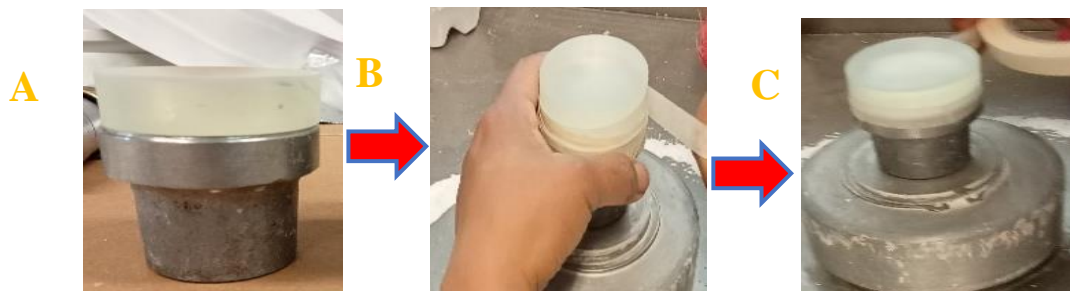
Figura 20. Descripción del proceso de pegado de la herramienta metálica con la piza de resina Clear.
