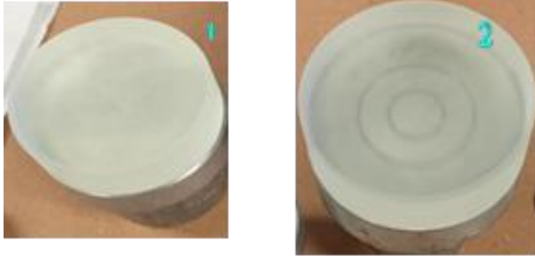
Figura 22. Piezas cóncavas de resina Clear antes del esmerilado enumerados (2" Ø R100) y 2 (3" Ø R200).
