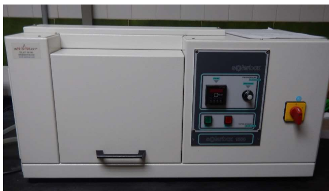
Figura 7. Fotografía del simulador solar utilizado en las pruebas de degradación.
