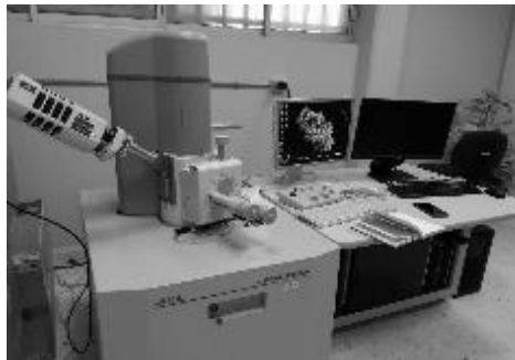
Figura 34. Equipo SEM modelo JS6510LV, Instituto de Ingeniería Civil, UANL.
