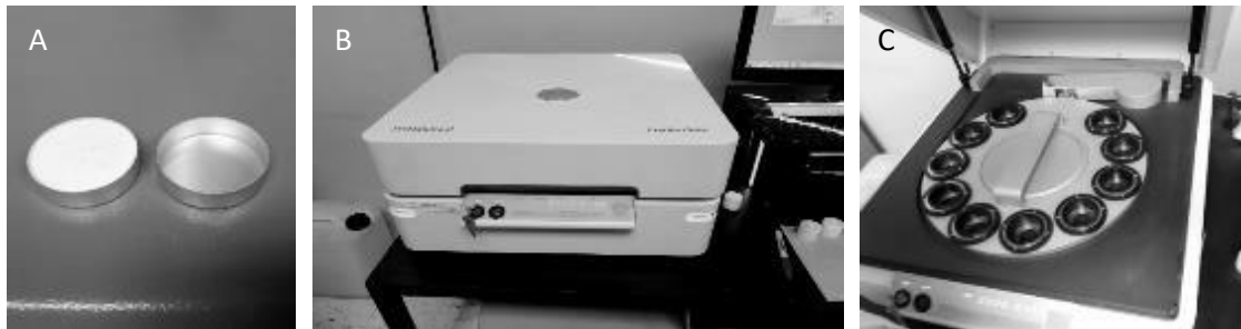
Figura 28. A) Pellets de mortero y molde de aluminio, B y C) Espectrómetro Epsilon 3XLE. EDXRF.
