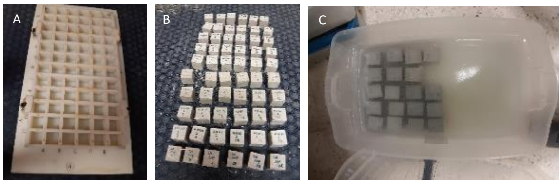
Figura 47. A) Molde para muestras de 1" X 1", B) Muestras obtenidas con diferentes condiciones tamaños de partículas y aditivos, C) Proceso de curado de muestras.
