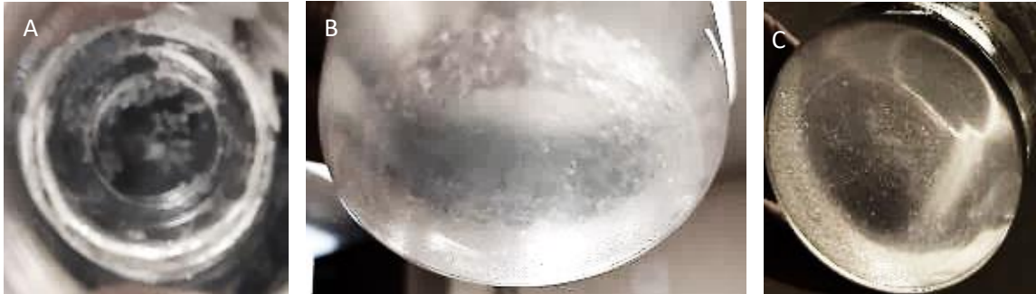
Figura 40. A) AS suspendido sobre el agua por condición hidrófuga, B y C) AS modificado por el aditivo COP, partículas hidrolizadas y sedimentadas.
