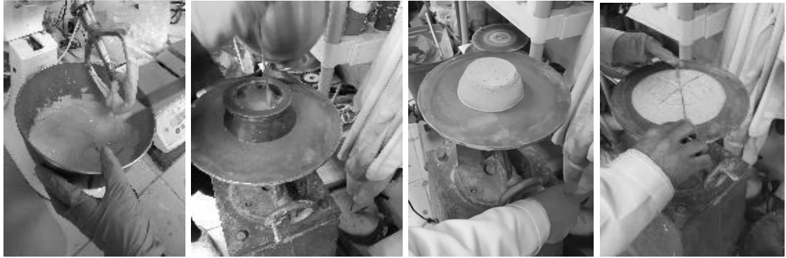
Figura 45. Proceso de mezclado, vaciado, desmoldado y medición de diámetros de la pasta después de los golpes en la mesa de medición.
