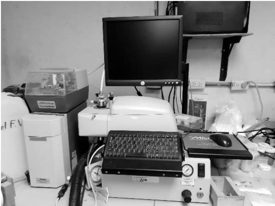
Figura 24. Equipo Microtrac S3500 de difracción láser para medición de distribución de tamaños de partículas.
