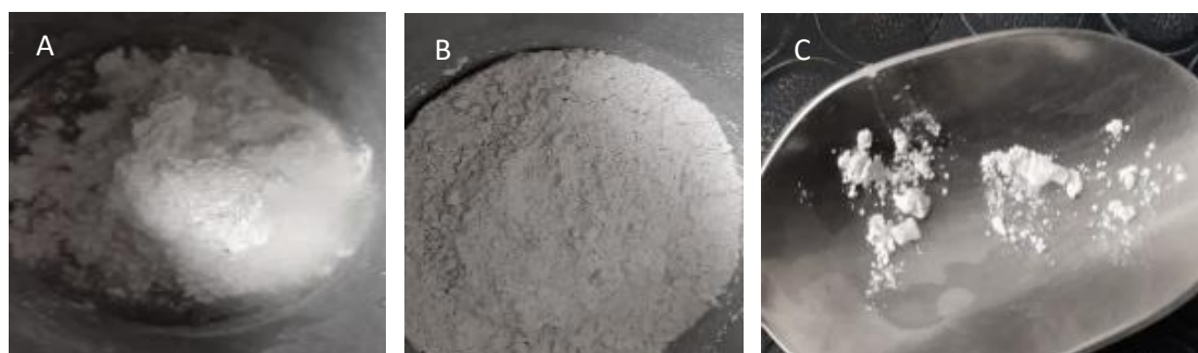
Figura 38. A) Inclusión de partículas de As, B) Resultado de la homogenización, grumos envolventes del AS, C) Observación de partículas de AS envueltas en los cementantes durante el proceso de homogenización.
