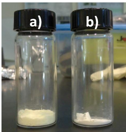
Figura 3. Nanoestructuras de ZnO con morfología tipo a) nanobarra y b) cuasiesférica.
