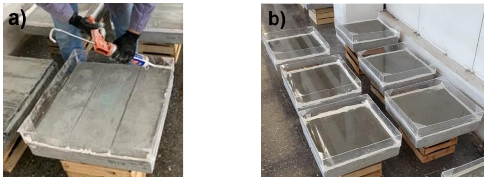
Figura 18.- a) Sellado de acrílico perimetral, b) Especímenes sometidos a exposición de sulfatos.
