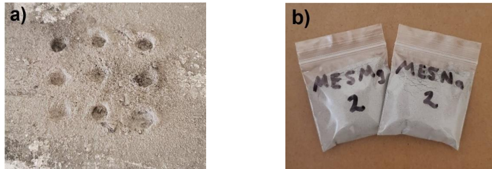
Figura 19.- a) Patrón de orificios para muestreo, b) Recolección de muestras.
