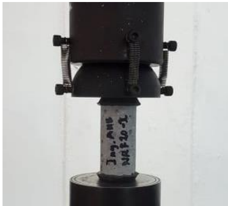
Figura 23.- Configuración de ensayo a compresión.
