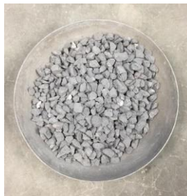
Figura 10.- Agregado grueso de 3/8 ' (sello).
