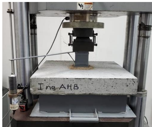
Figura 21.- Configuraci3n de ensayo a flexi3n.
