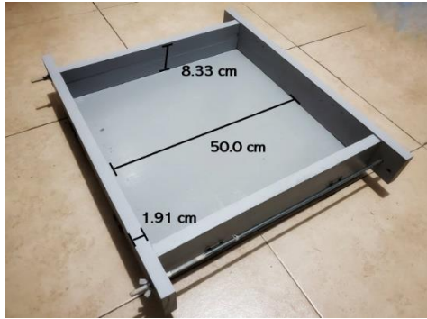
Figura 15.- Moldes de madera utilizados como cimbra.
