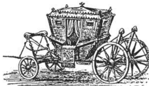
Fig. 2.1 Carruaje tirado por caballos con suspensión de ruedas, resortes, frenos y dirección. [29]
