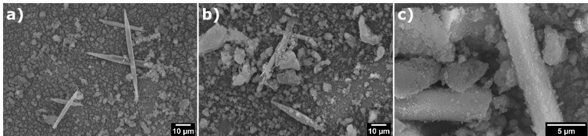
Figura 27. Micrografías de SEM para los depósitos sobre acero inoxidable antes (a) y después (b, c) del proceso de conversión en HA a 1 000X (a, b) y 5 000X (c).
