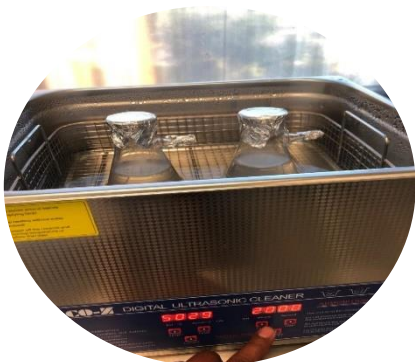
Figura 7. Dispersión de nanopartículas en ultrasonido
