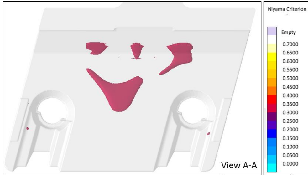
Figura 32: Resultado del criterio de Niyama de la simulación de la solidificación natural de la pieza, mostrando la vista A-A.
