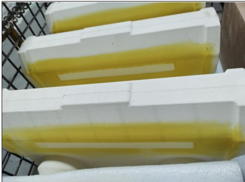
Figura 46: Corazón fabricado con chill, pintado con refuerzo base cromita.
