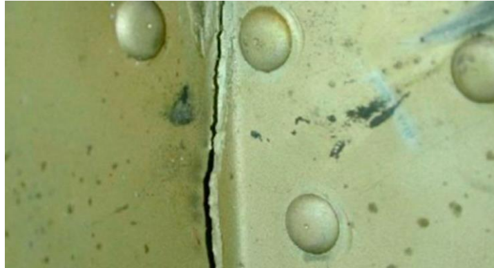
Figura 2. 17. Corrosión bajo tensión en un componente de aeronave [38].
