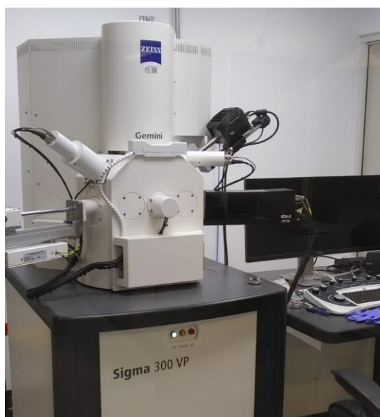
Figura 3. 8. Microscopio Electrónico de Barrido de Emisión de Campo. Marza Zeiss. Modelo Gemini Sigma 300 VP.
