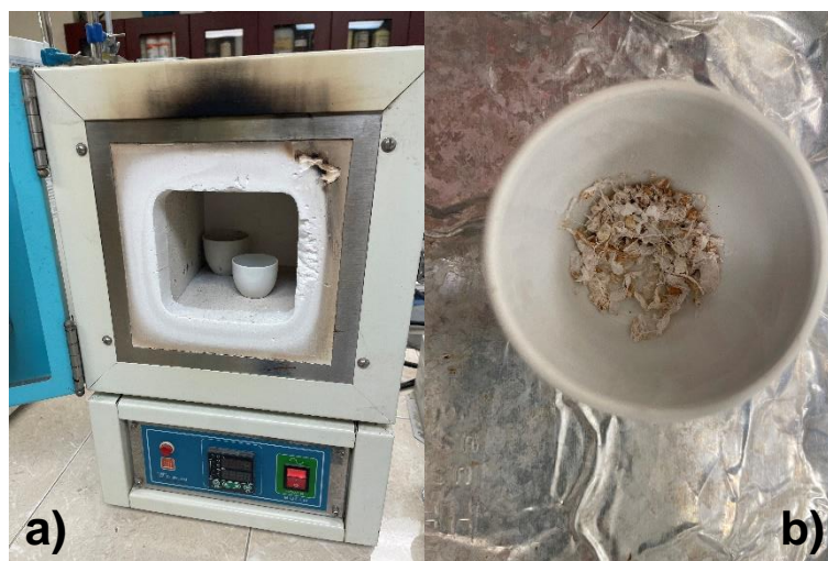
Figura 20. a) Muestras en la mufla, b) Muestras después del proceso de calcinación
