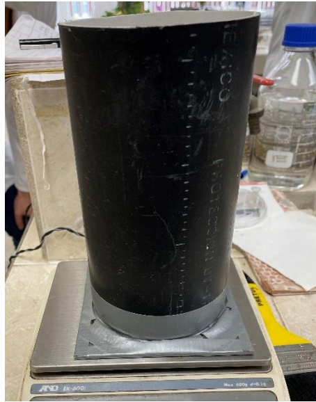
Figura 15. Molde usado para el cálculo de la densidad aparente.
