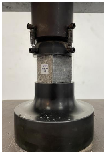
Figura 30. Ensayo de los cubos.
