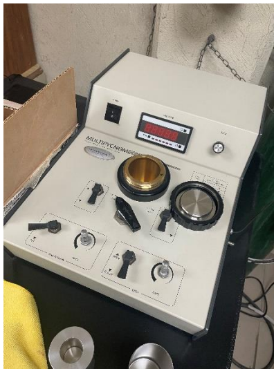
Figura 16. Multipicnometro para el cálculo de densidades.
