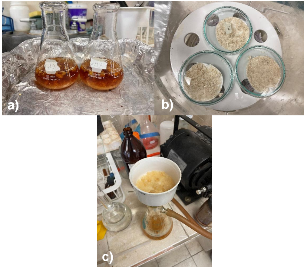
Figura 24. a) Muestras con NaOH, b) Proceso de filtrado a vacío, c) Muestras secas
