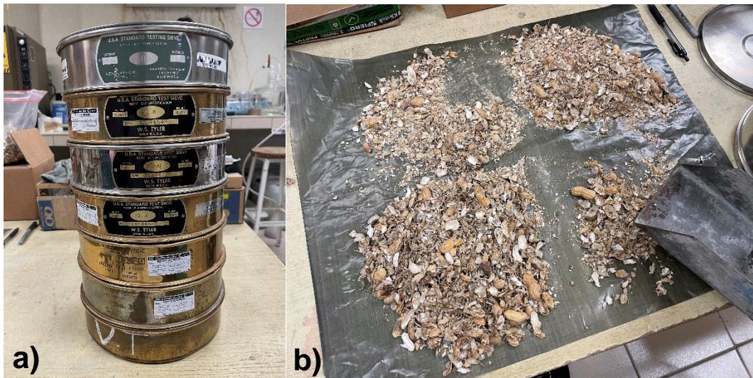
Figura 14. a) Tamices utilizados, b) Proceso de cuarteo
