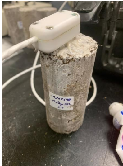
Figura 31. Medición de conductividad térmica.
