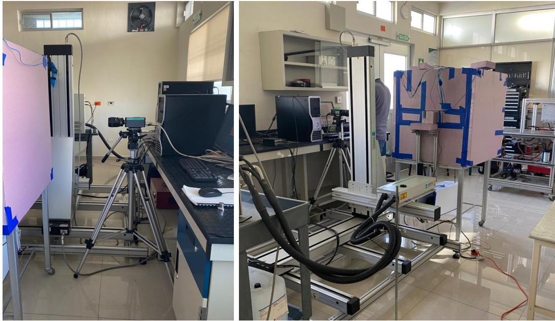
(a) Instalación de cámara HiSense.
