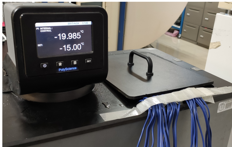
(b) Baño térmico en calibración de termopres
