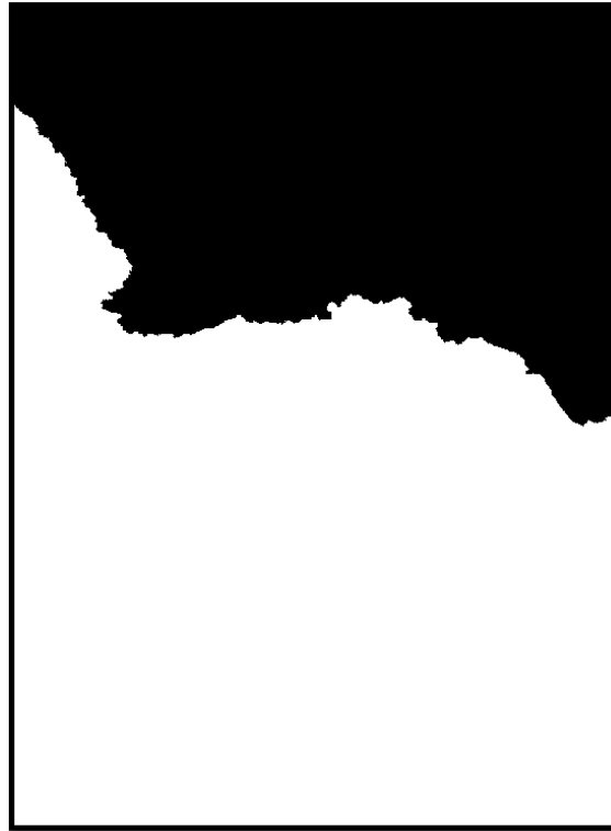
Figura 3.40: Imagen binarizada de la captura del frente de fusión
