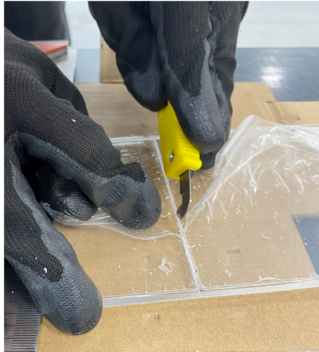
Figura 3.20: Corte de de acrílico con navaja
