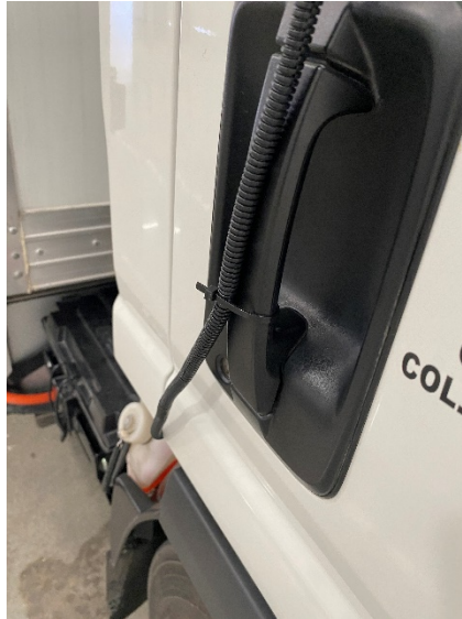
Figura 4.14. Fijación de la manguera corrugada.
