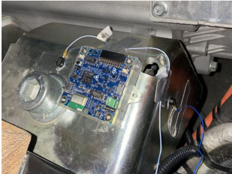
Figura 4.13. Ubicación del módulo STWINKT1 en el soporte de motor.
