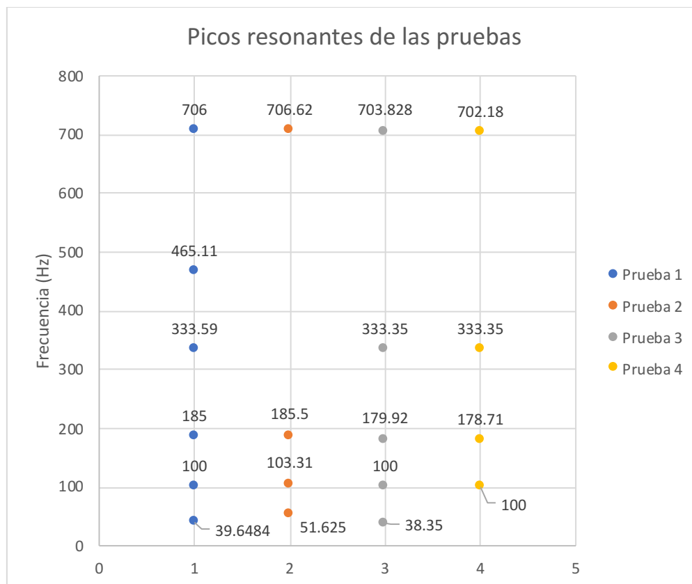
Figura 6.18. Picos resonantes de las 4 pruebas del camión.
