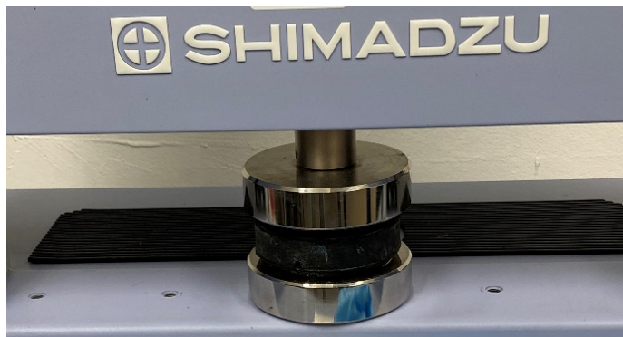
Figura 4.20. Posicionamiento de la parte inferior del cojinete en la máquina.
