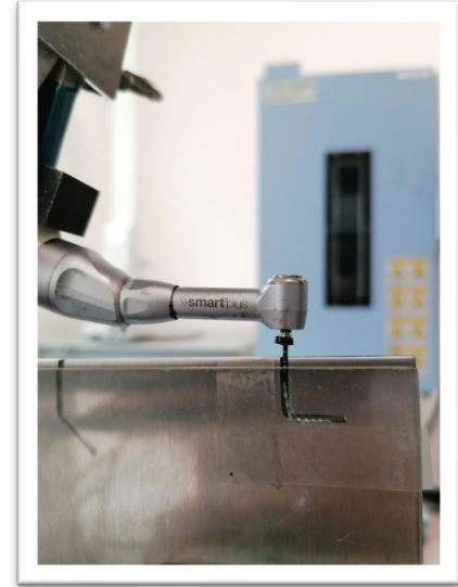
Figura 17. Instrumento DC Taper H en ángulo de 90°
