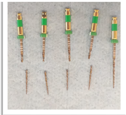
Figura 22. Instrumentos Wave One Gold fracturados
