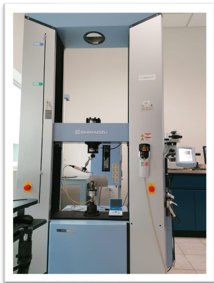
Figura14.Máquina Shimadzu, AG-X (1kN-100kN)
