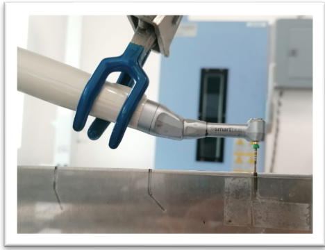
Figura 20. Instrumento Wave One Gold en ángulo de 90°
