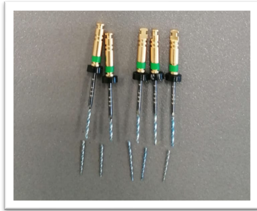
Figura 26. Instrumentos DC Taper H fracturados.
