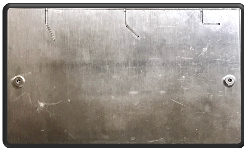
Figura 12. Dispositivo acero inoxidable con 3 curvaturas diferentes.
