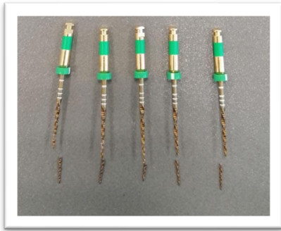
Figura 22. Instrumentos Wave One Gold fracturados
