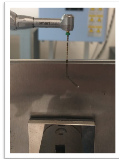
Figura 19. Instrumento Wave One Gold en ángulo de 45°
