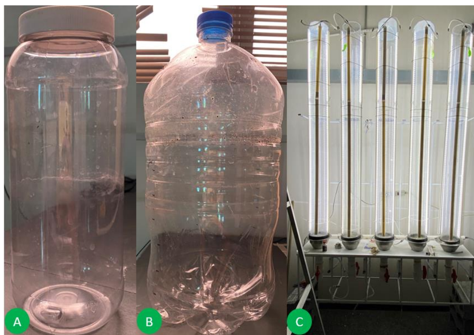
Figura 4.5. Fotobiorreactores utilizados A) fotobiorreactor de 1 L, B) fotobiorreactor de 5 L, C) batería de fotobiorreactores 25 L c/u.
