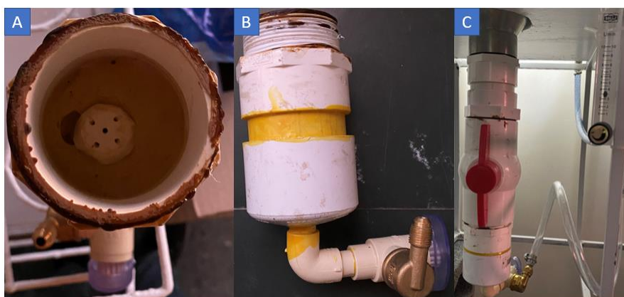
Figura 4.6. Dispositivo de aireación. A) vista superior, B) vista lateral, C) dispositivo conectado.
