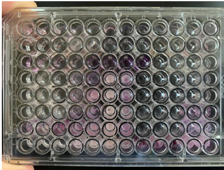
Figura 3: Placa de 96 pocillos de prueba de viabilidad celular para obtener lectura en espectrofotómetro.
