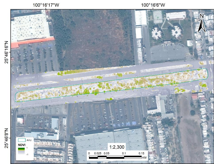
Figura 103. Índice NDVI calculado para el polígono ESC3 (av. Sendero) en el ortomosaico de fotorreconstrucción obtenida a través de VANT (Elaboración propia).
