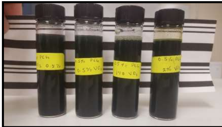
Figura 9. Pruebas de nanosuspensiones 0.25%, 0.5%, 1% y 2% VO 2 (M) utilizando PEG como dispersante.
