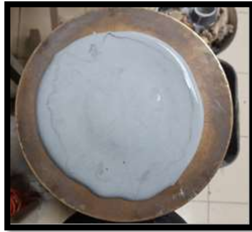
Figura 10. Pruebas de fluidez de las mezclas de \text{VO}_2(\text{M})/\text{MWCNTs}/\text{yeso} .
