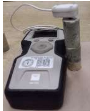
Figura 20. Prueba de conductividad térmica a espécimen de yeso.
