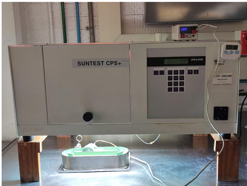
Figura 24. Sistema experimental para la degradación de LEV
