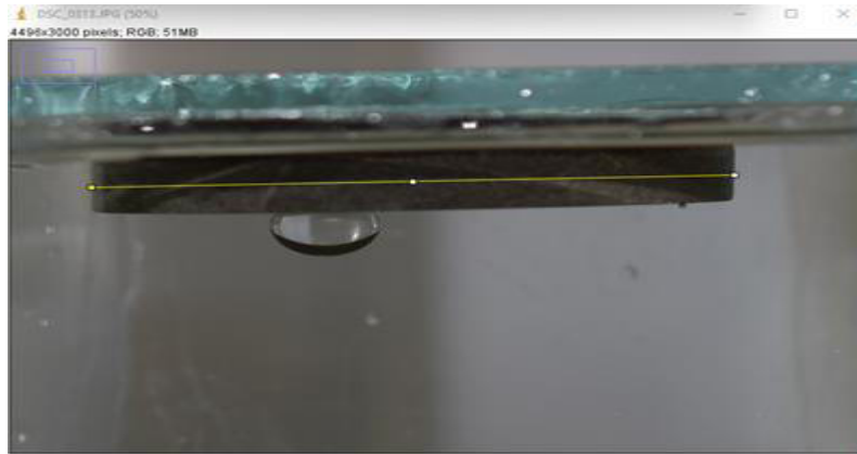
Figura 11.4. Discos de roca como objeto de referencia para determinar el tamaño real de las gotas.
