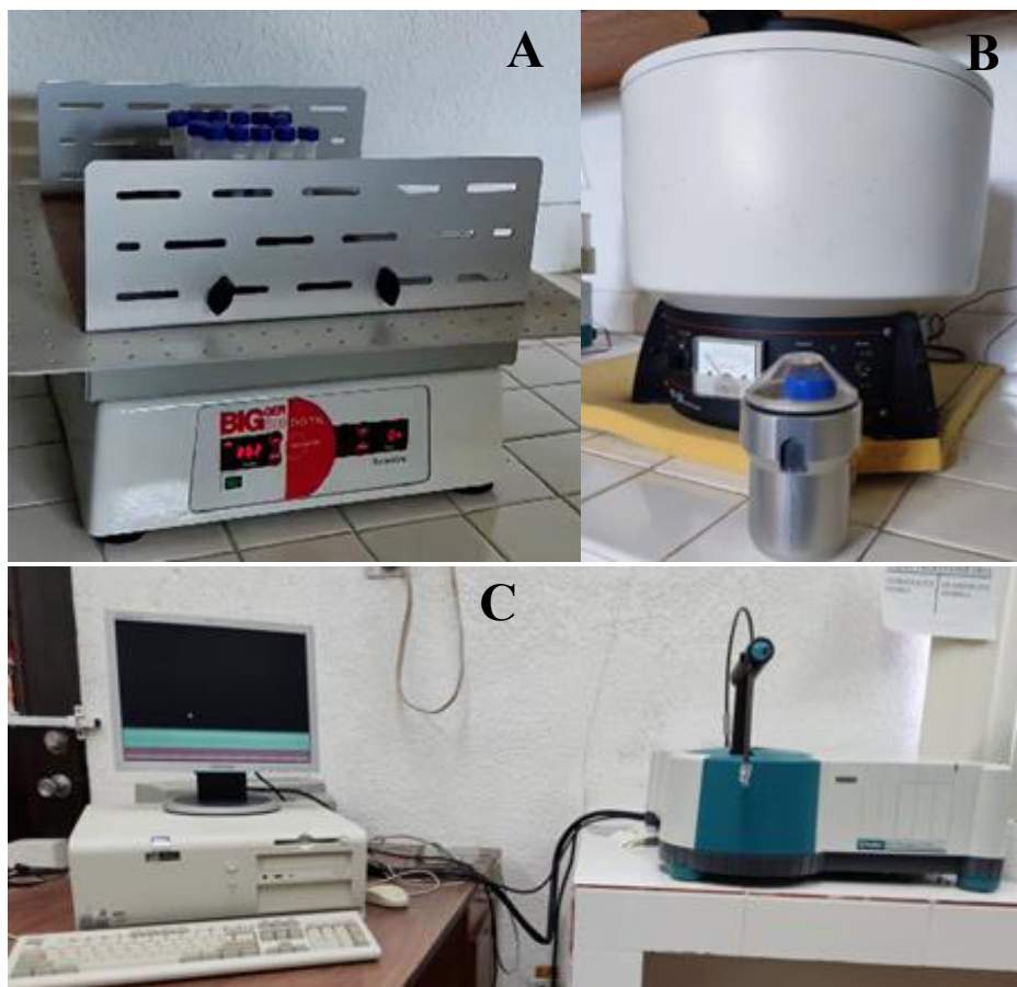
Figura 12.10. Equipos empleados en la preparación y medición de adsorción de soluciones acuosas. (A) Equipo de agitación mecánica empleado durante el proceso de adsorción. (B) Centrífuga usada para la separación de los sistemas sólido (muestra de roca) y líquido (solución con surfactante CTAB). (C) Espectrofotómetro para determinar la concentración de CTAB.
