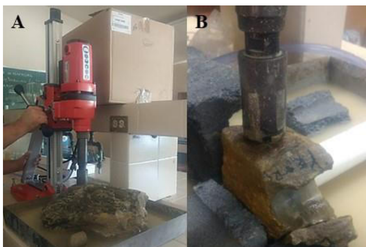
Figura 3.2. Corte de núcleos en muestras de rocas. En A se muestra el perforador de núcleos. En B se visualiza la disposición de la barrena en corte cilíndrico con dirección paralela a la estratificación.
