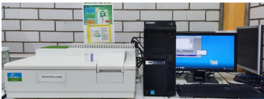
Figura 12.13. Equipo de espectrofotometría UV-vis utilizado para la determinación de concentraciones finales alcanzadas por adsorción.
