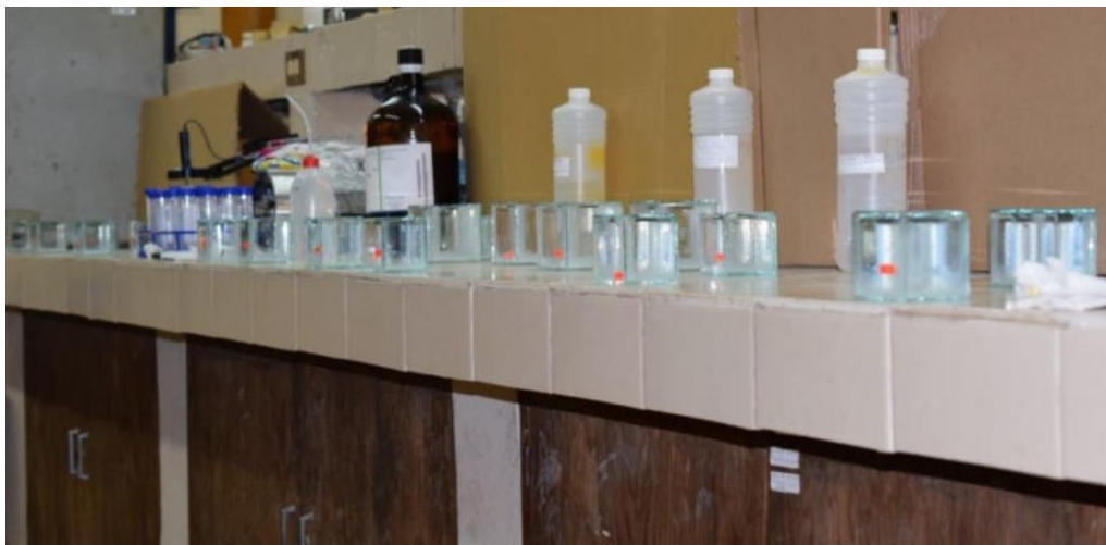
Figura 10.7. Serie experimental para determinación de mojabilidad. Se muestra la disposición para el periodo de remojo.
