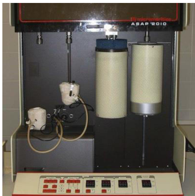
Figura 6.3. Aparato para fisisorción utilizado para determinar características texturales del sólido.
