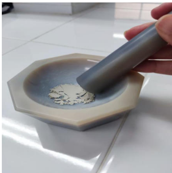
Figura 8.8. Muestra de roca molida en mortero de ágata para la elaboración de pastillas requeridas en el análisis de espectroscopía infrarroja.
