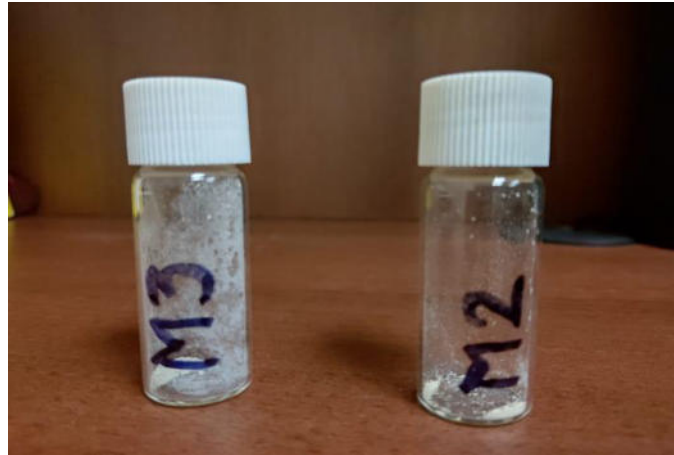
Figura 8.6. Muestras de rocas pulverizadas y destinadas al análisis de espectroscopía infrarroja. M3 corresponde al afloramiento Amaxac y M2 al afloramiento Chicontepec.
