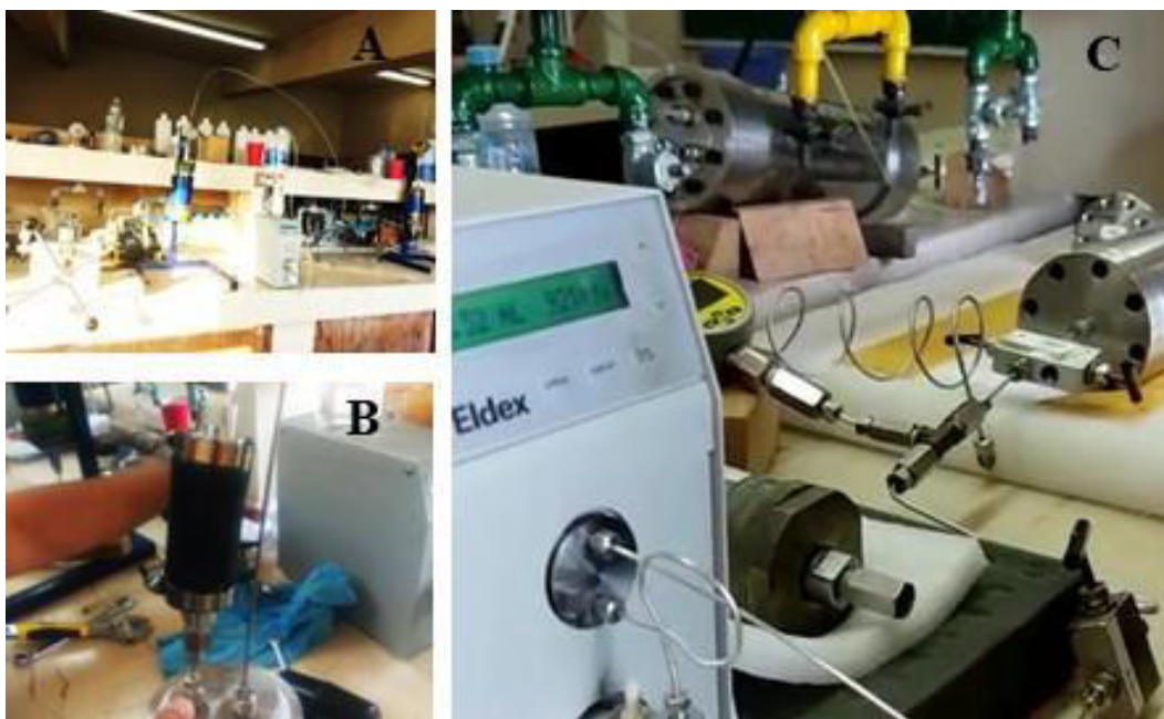
Figura 3.4. Preparación y montaje del equipo de desplazamiento. (A) Sección de montaje del equipo de desplazamiento. (B) Núcleo cubierto con manga negra para ser introducido en el tubo de desplazamiento. (C) Se muestra parcialmente inicio de desplazamiento de fluido en mediciones petrofísicas de núcleos de roca.
