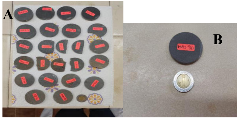
Figura 10.4. Muestras de rocas con superficies pulidas. (A) y (B) Ilustran muestras circulares y semicirculares de rocas pulidas y niveladas horizontalmente para las mediciones de ángulo de contacto. En la imagen B se detalla esta condición física adquirida por desbaste de la roca con los diferentes niveles de lijas.
