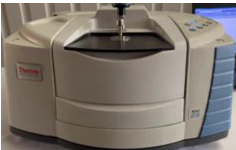
Figura 8.10. Equipo de espectroscopía infrarroja del laboratorio de Polímeros de la Facultad de Ciencias Químicas, Universidad Autónoma de San Luis de Potosí.
