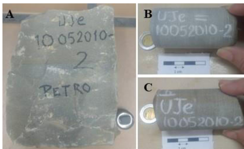
Figura 3.1. Muestras de roca de afloramientos Amaxac y Chicontepec. Los núcleos de las imágenes B y C corresponden al afloramiento Chicontepec, seccionados en dirección paralela y perpendicular con relación al bloque de roca señalado en la imagen A.
