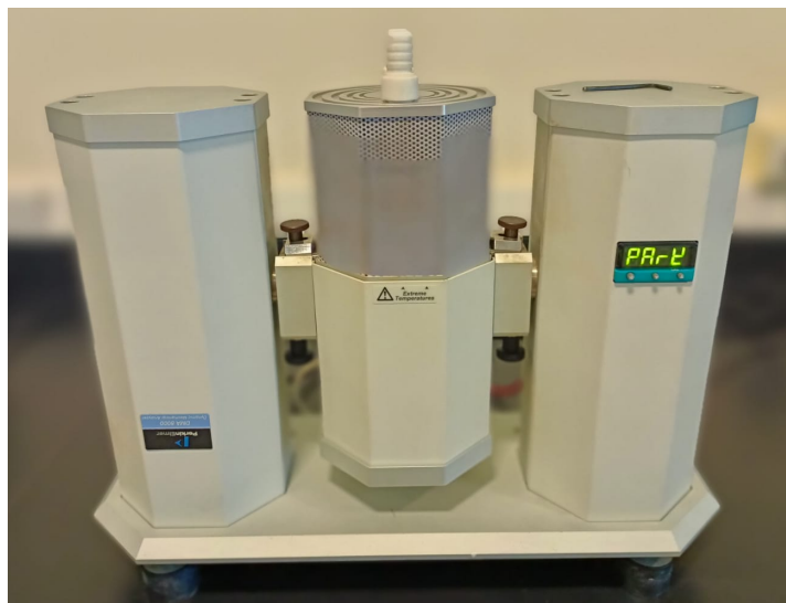
Figura 21. Equipo Dynamic Mechanical Analyzer modelo PerkinElmer DMA 8000.
