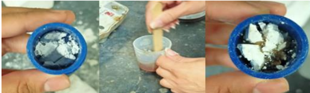
Imagen 26. Preparación de muestras con resina.
