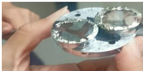
Imagen 29. Colocación de muestras con cinta de cobre para SEM.
