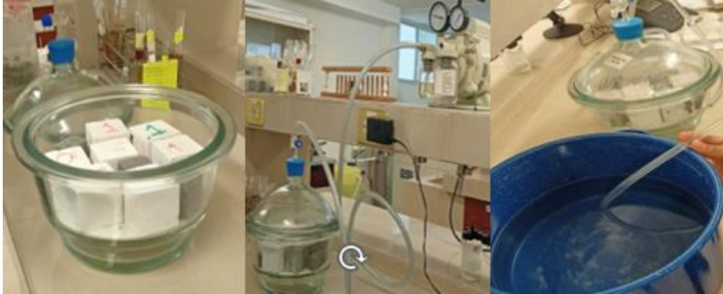
Imagen 19. Proceso de vacío que se llevo acabo para determinar porosidad, absorción y densidad.
