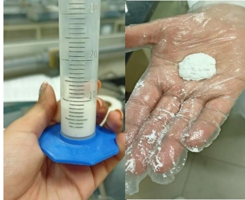
Imagen 14. Preparación de muestra base de concreto de alta alúmina usando el método de bola en mano.
