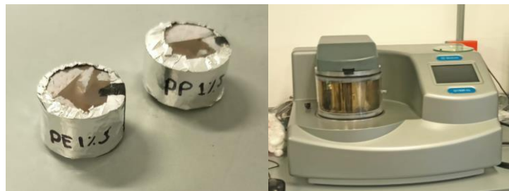
Imagen 28. Recubrimiento de muestras.
