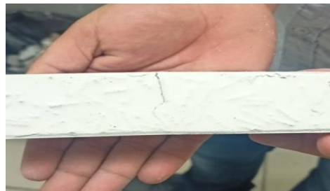
Imagen 25. Muestra de PET 1% después de haber sido sometida al ensayo de flexión.
