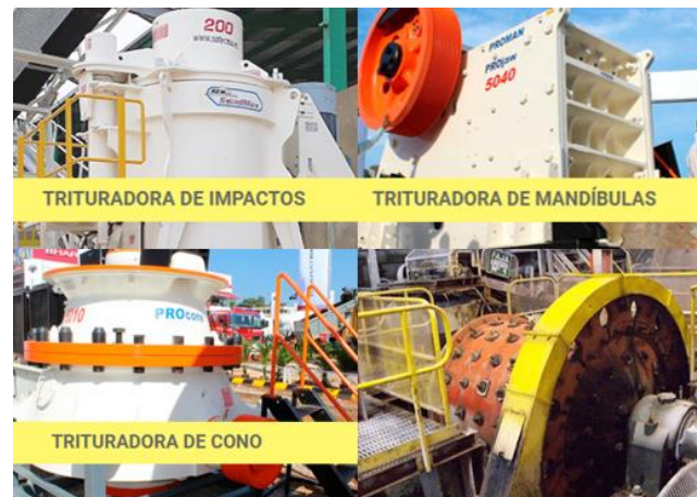
Figura 3. Equipos Industriales utilizados para moler o triturar la materia prima. a) Trituradora de Impactos, b) Trituradora de Mandíbulas, c) Trituradora de Cono y c) Molino de Bolas.
