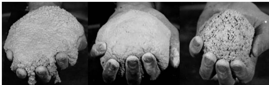
Imagen 13. Método de bola en mano para preparación de concretos.
