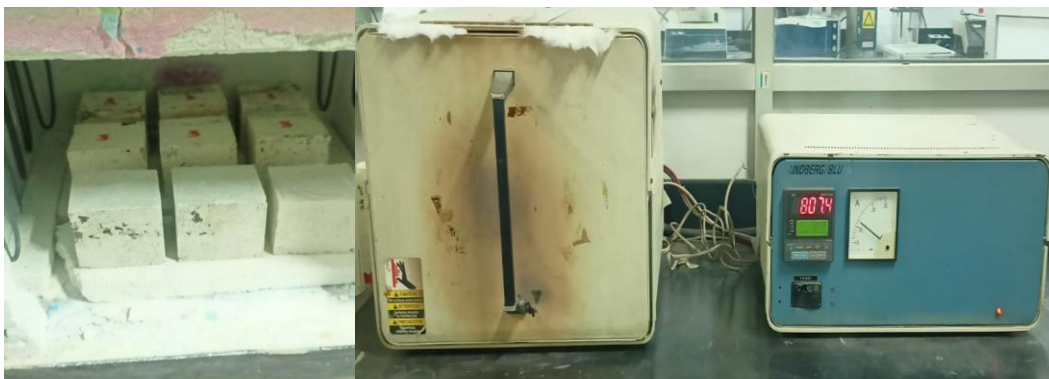
Imagen 17. Muestras sometidas al horno para quemarlas a las temperaturas 815 y 1,050°C.
