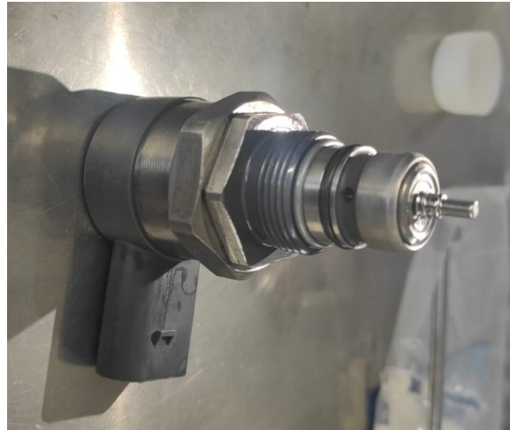
FIGURA 4.17: Válvula reguladora de presión.
