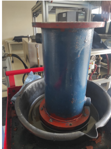
FIGURA D.1: Intercambiador de calor
