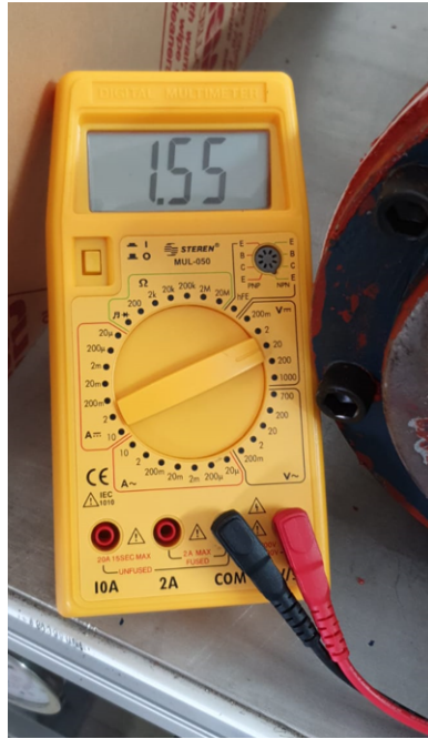
FIGURA B.4: Medición del voltaje del sensor de presión de inyección.
