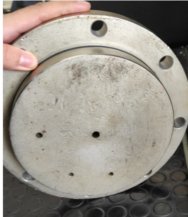
FIGURA A.1: Tapa de la cámara de visualización a volumen constante antes de ser pintada.
