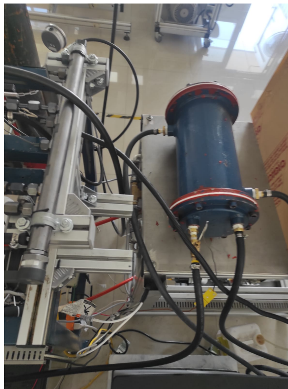
FIGURA 4.19: Intercambiador de calor b.
