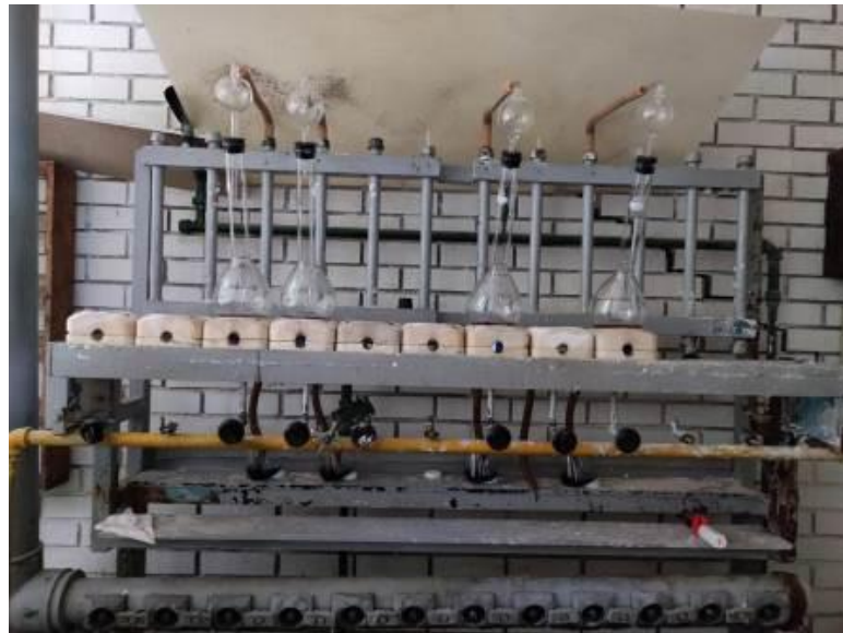
Figura 14. Proceso de digestión con Ácido sulfúrico concentrado.
