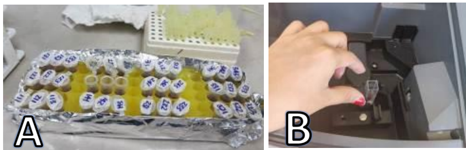
Figura 20. (A) Preparación de muestras con DPPH y (B) Lectura de muestras en el espectrofotómetro.
