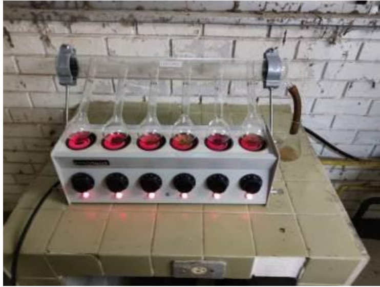
Figura 8. Determinación de nitrógeno en suelo por el método Micro-Kjeldahl.
