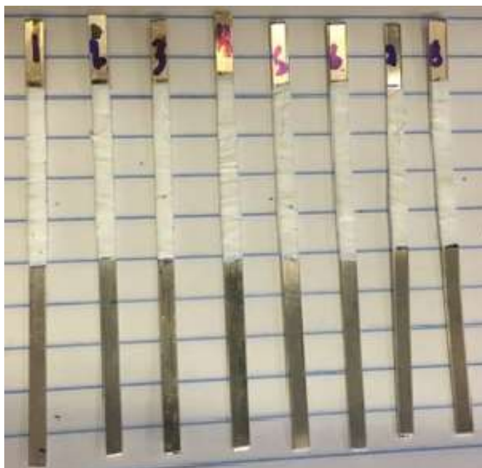
Figura 5. Electrodos número del 1, 2, 3, 4, 5, 6, 7 y 8, antes de su preparación de ZnO-2D incrustados en un bisel de alambre de Ag.
