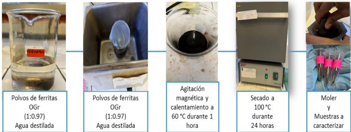
Figura15. Diagrama de la ruta de síntesis por ultrasonido para la obtención de \text{OGr/Mn}_{0.5}\text{Zn}_{0.5}\text{Zr}_x\text{Fe}_{2-x}\text{O}_4 con x=0.5, 0.10 y 0.15
