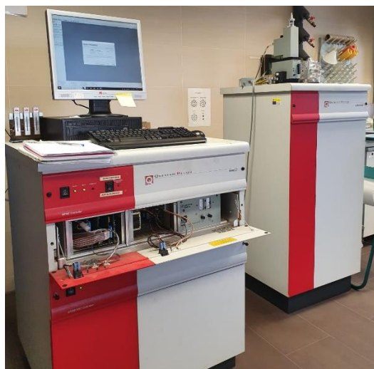
Figura 27. Equipo SQUID modelo Quantum Design MPMS XL con EverCool
