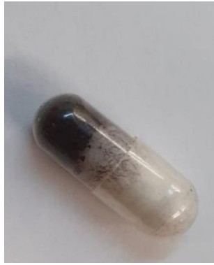
Figura 25. Cápsula con muestra en polvos de ferritas para su análisis en el VSM
