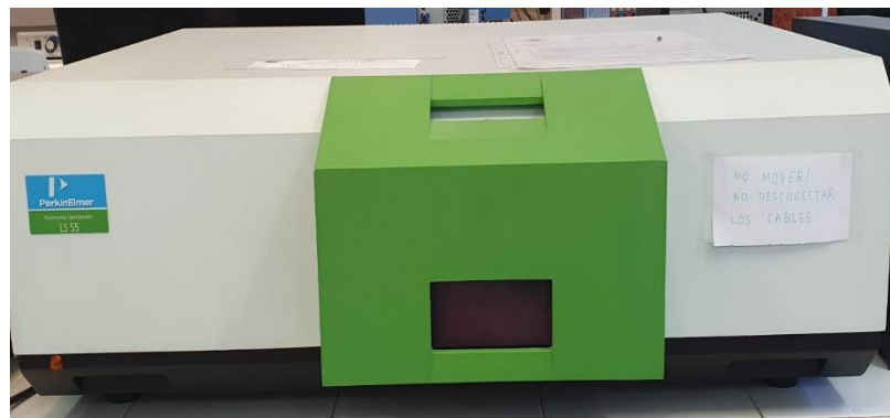
Figura 24. Equipo de espectroscopia de fotoluminiscencia modelo PerkinElmer, Fluorescence Spectrometer LS 55
