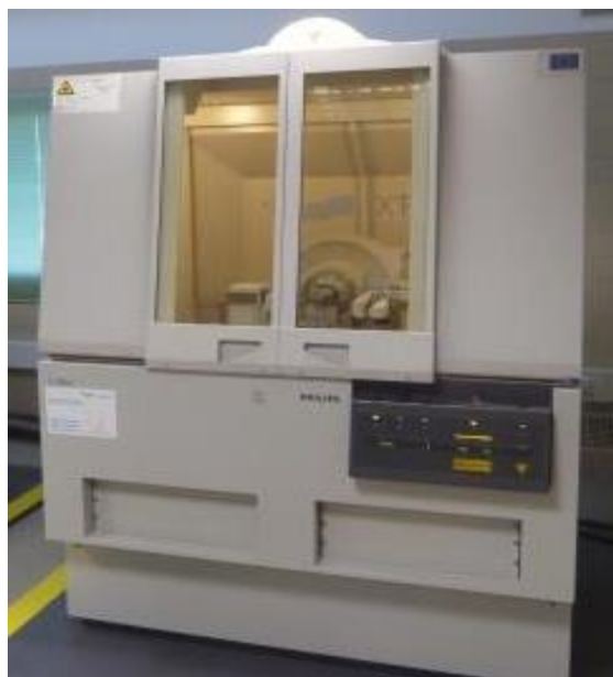
Figura 17. Difractor de Rayos X, marca Philips (PANALYTICAL) modelo X'Pert MPD
