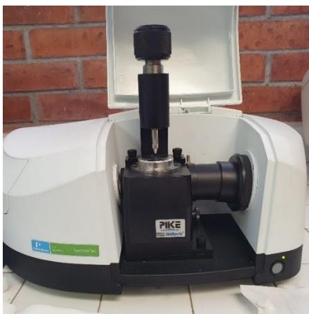
Figura 18. Espectrómetro Spectrum Two FT-IR marca Perkin Elmer
