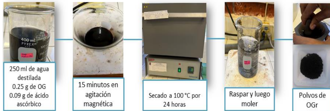
Figura 14. Diagrama de la ruta de síntesis de la etapa de reducción del OG para la obtención de óxido de grafeno reducido
