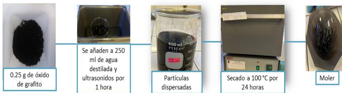
Figura 13. Diagrama de síntesis por el método Hummers modificado (etapa de exfoliación) para la obtención de óxido de grafeno
