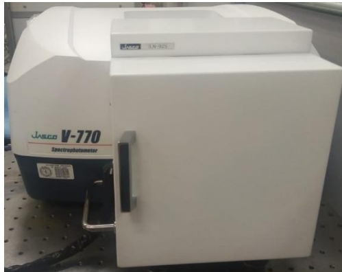
Figura 19. Espectrómetro UV-Vis modelo Jasco V-770 con espectroscopia de reflectancia difusa (ERD)
