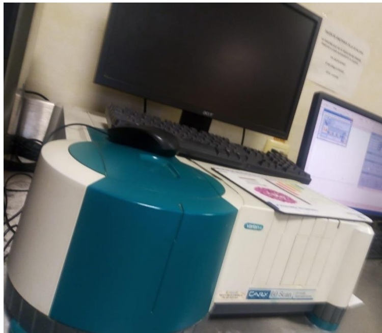
Figura 21. Espectrómetro UV-Vis modelo Varian Cary 50
