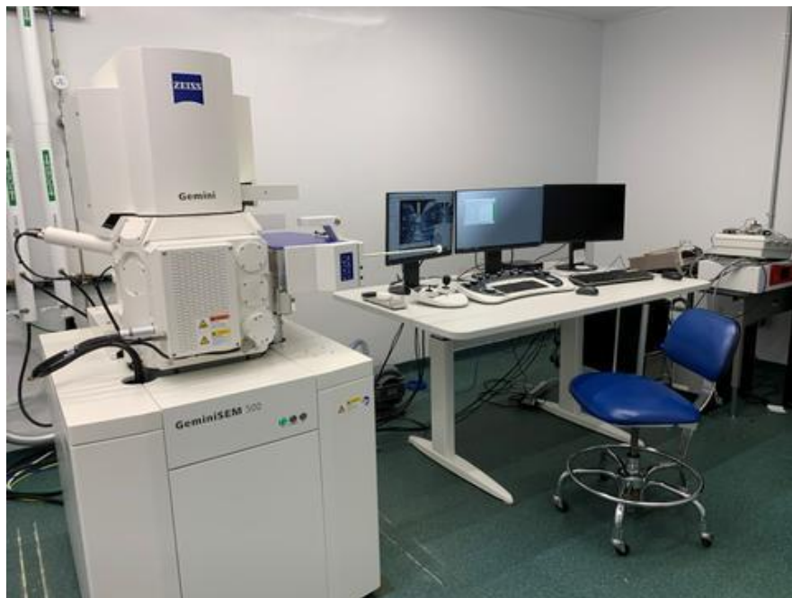
Figura 23. Microscopio electrónico de barrido de emisión de campo modelo GeminiSEM 500
