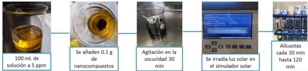
Figura 30. Diagrama de pruebas fotocatalíticas
