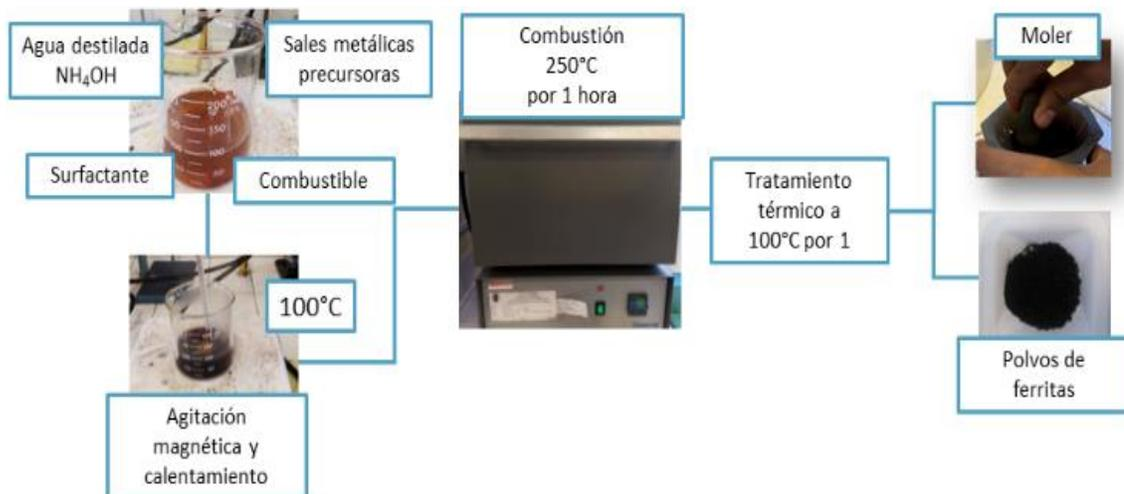
Figura 11. Diagrama de ruta final (con ajustes de parámetros) de síntesis por el método de auto combustión sol-gel asistido por CTAB para la obtención de las NP's de ferritas  $Mn_{0.5}Zn_{0.5}Zr_xFe_{2-x}O_4$  con  $x=0.05, 0.10$  y  $0.15$
