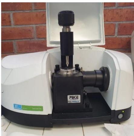
Figura 18. Espectrómetro Spectrum Two FT-IR marca Perkin Elmer
