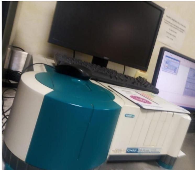
Figura 21. Espectrómetro UV-Vis modelo Varian Cary 50
