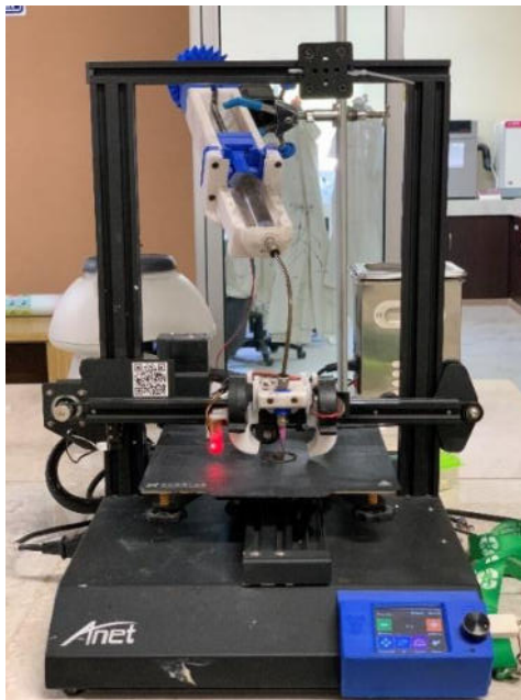
Figura 10 Impresora 3D Anet-ET4 Pro modificada para la impresión de pastas.
