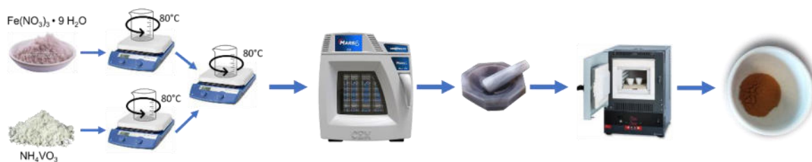
Figura 6. Metodología para la síntesis de FeVO 4 mediante Hidrotermal asistido con Irradiación de Microondas.
