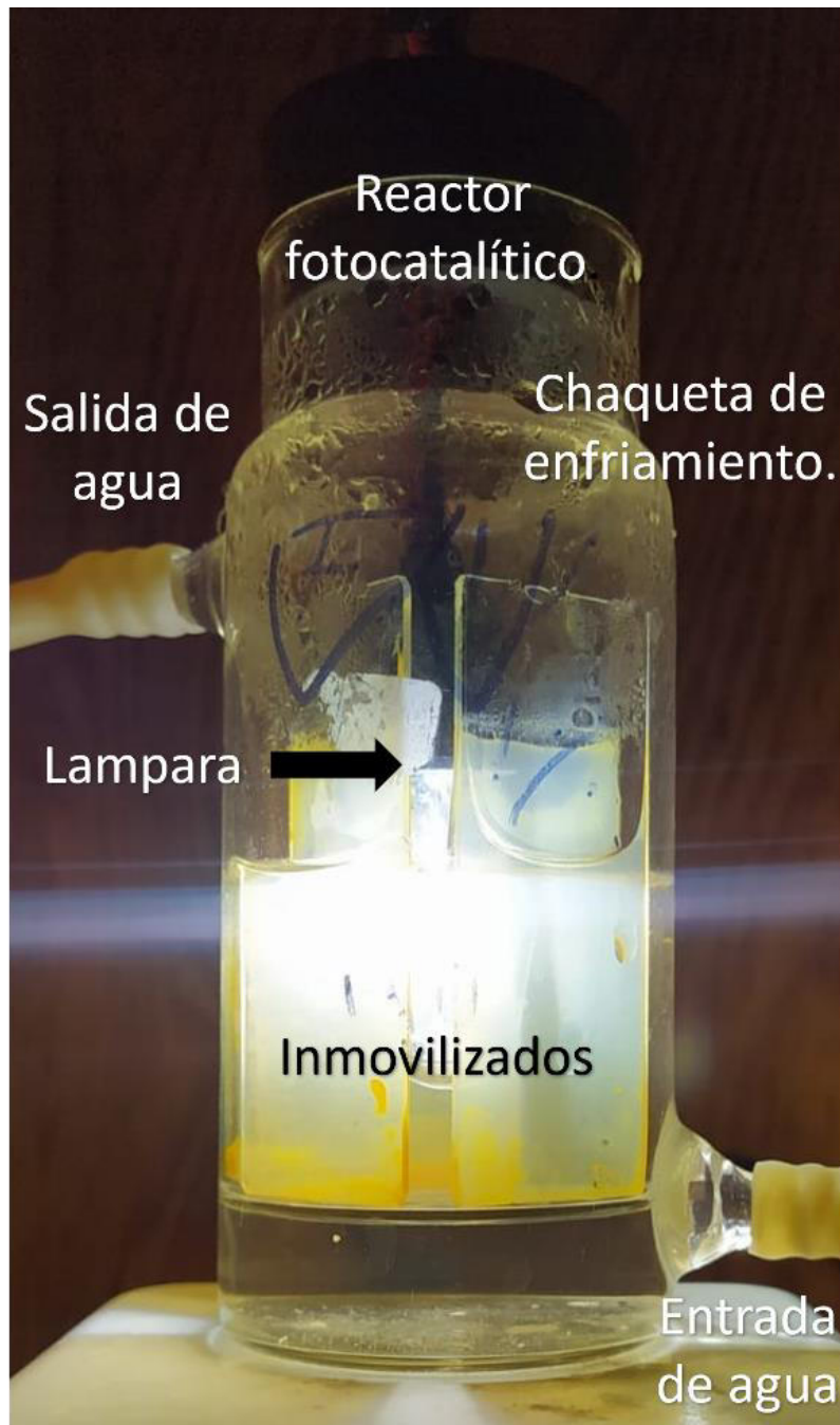
Figura 12. Reactor fotocatalítico con inmersión de lampara.
