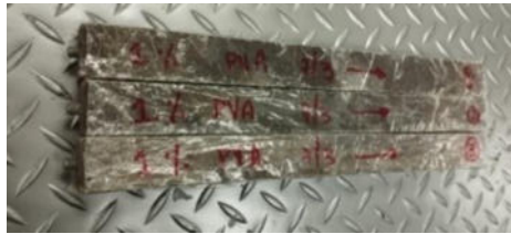
Figura 14. Vigas de 2.5x2.5x28 cm elaboradas para los especímenes de variación de longitud.
