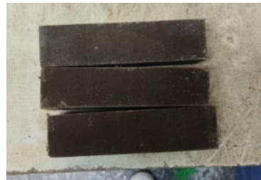
Figura 13. Vigas de 4x4x16 cm elaboradas para los especímenes de flexión a 4 puntos.
