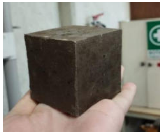
Figura 12. Cubo de 5x5x5 cm elaborado para los especímenes de compresión.
