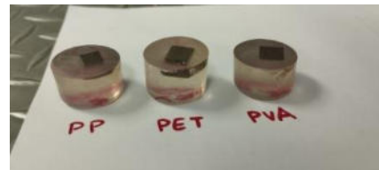
Figura 17. Muestras de 0.5x0.5x0.5 cm preparadas con resina para el análisis en el SEM
