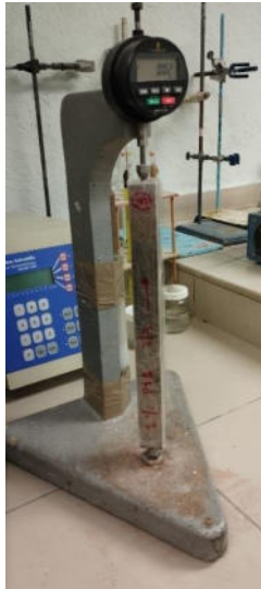
Figura 19. Ensayo de variación de longitud por contracción por secado.
