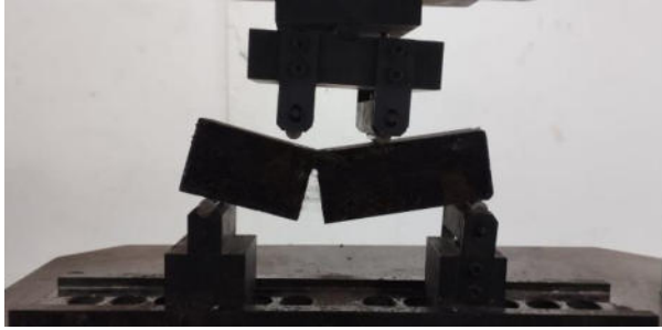
Figura 18. Viga ensayada a flexión en 4 puntos.
