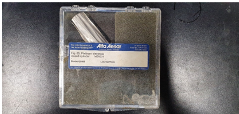
FIGURA 3.13: Electrodo auxiliar de platino con forma cilíndrica cerrada.
