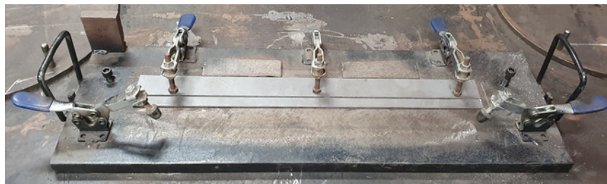
FIGURA 3.5: Base para soldar los cupones del estudio.
