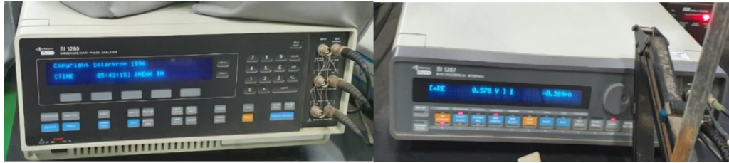
FIGURA 3.14: Sistema potenciostato-galvanostato Solartron SI1287.
