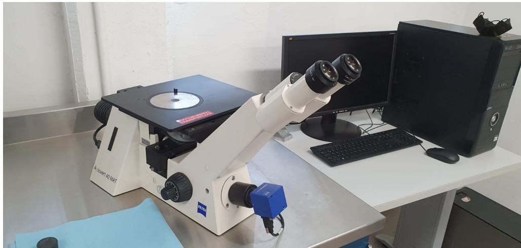
FIGURA 3.21: Imagen del microscopio Zeiss Axiovert 40 Mat utilizado para el análisis de microscopía óptica.
