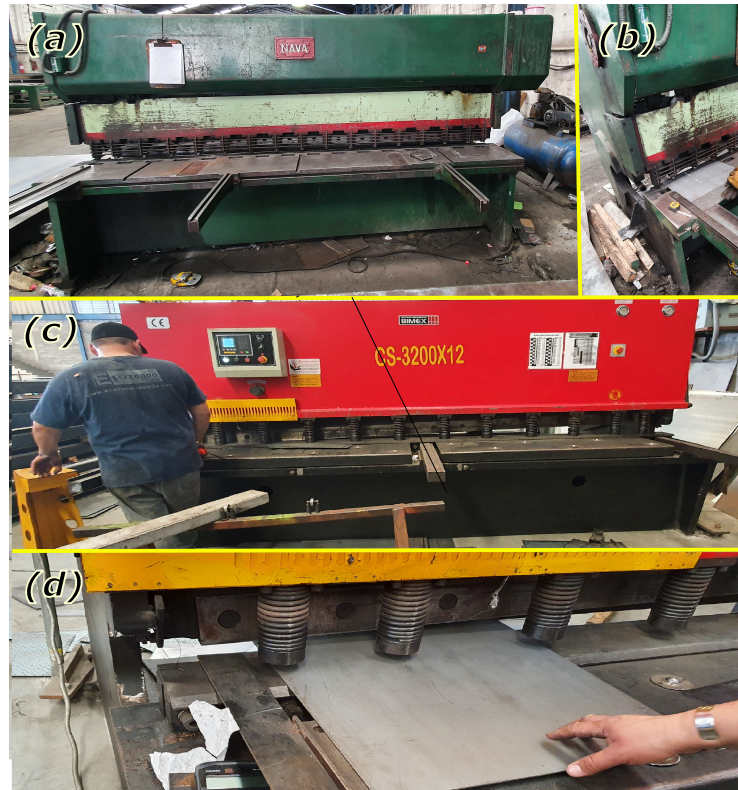
FIGURA 3.1: (a) Guillotina marca NAVA utilizada para el corte de las placas del primer estudio de penetración. (b) Proceso de corte de las placas a medida 120 mm x 510 mm. (c) Guillotina marca BIMEX utilizada para el corte de las placas del segundo estudio de penetración y coupons del estudio final. (d) Proceso de corte de las placas a medida 120 mm x 510 mm.
