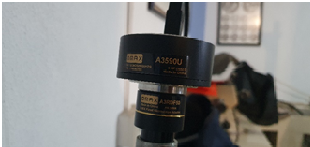
FIGURA 3.10: Camara OMAX modelo A3590U de 9 megapixeles con adaptador fijo para microscopio de 0.50X marca OMAX modelo A3RDF50.
