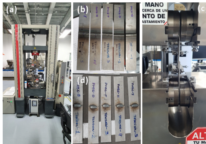
FIGURA 3.17: (a) Máquina universal Zwick/Roell Z250. (b) Imagen de probetas de cordón de soldadura continua. (c) Imagen de prueba en proceso. (d) Imagen de probetas de cordón de soldadura intermitente.
