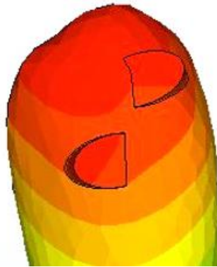
Figura 35. Zonas de tensión en el modelo del aditamento Double Round Wedge (Apex, 2021)
