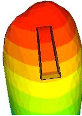
Figura 34. Zonas de tensión en el modelo del aditamento Rectangular 5 mm (Apex 2021)
